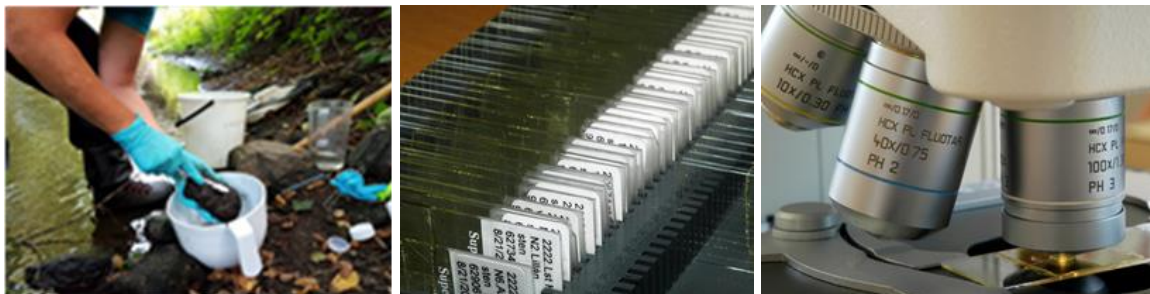
Figur 1. Provtagning av kiselalger görs i första hand från sten genom att påväxten borstas av. Kiselalgskalen prepareras fram och fixeras på objektglas. Kiselalgsanalys görs i ljusmikroskop i 1000 gångers förstoring med oljeimmersionsobjektiv. Mikroskopet ska helst vara utrustat med interferenskontrast, vilket gör att man kan se mycket små former tydligare än med andra tekniker.
