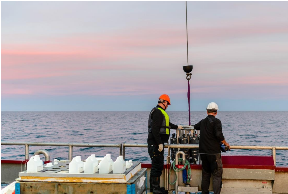
Foto 2. Vattenprovtagning med multivattenhämtaren.
