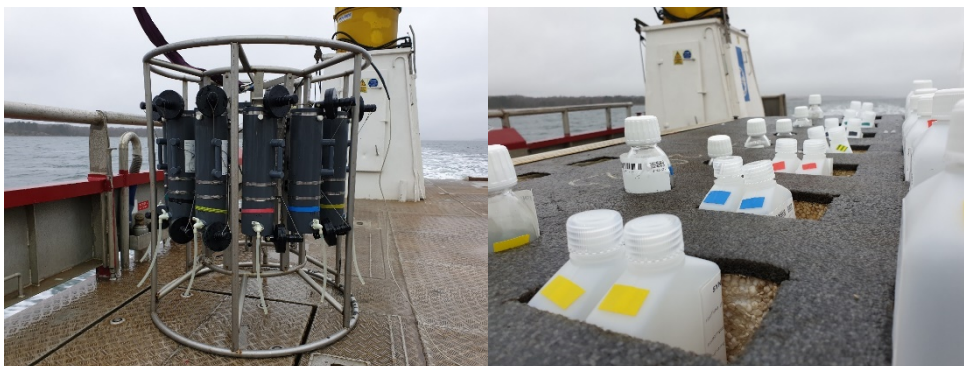
Foto 2. Foto på vattenhämtare (till vänster) och uppställda provflaskor (till höger) på båtdäcket vid provtagning.
