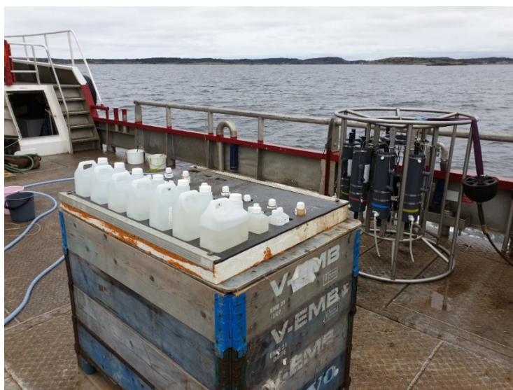
Multivattenhämtare som används vid vattenprovtagning
