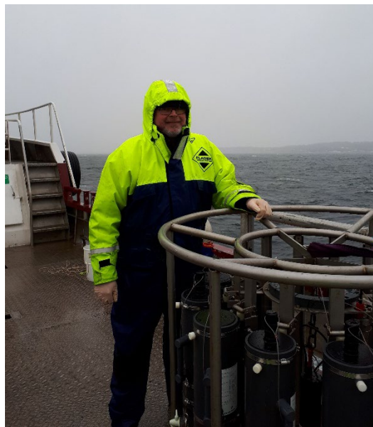
Provtagning utförs med multivattenhämtare
