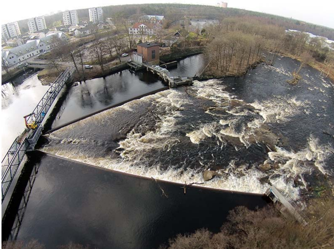
Figur 6. Den nya naturliknande fiskvägen vid Hertings kraftverk anlades år 2013 i syfte att skapa fria vandringsvägar för fisk av alla förekommande storlekar och arter
