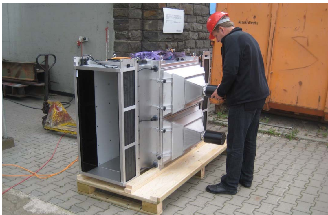
Figur 10. Vaki RWC fiskräknare med från vänster till höger i bild: extra hög skannerenhet och fototunnel med två luftfyllda kamerakoner. Mitt på varje kamerakon syns ett kamerahus när skyddskåpan är avtagen.
