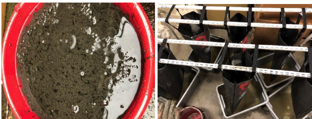
Figur 15. Förstudier genomfördes med sediment från Barnarpssjön för val av polymer och typ av geotextilsäck.
