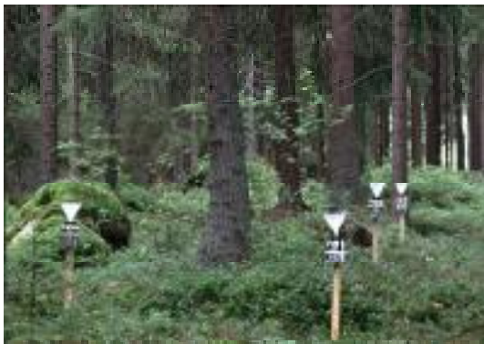
Depositionsmätning på en skogsyta (krondropp). Trädkronorna fungerar som provtagare och filterar torra partiklar, gaser och aerosoler från luften. Föroreningarna sköljs sedan ner av nederbörden och samlas upp i trattförsedda dunkar. Foto: Per-Erik Larsson
