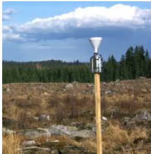
Depositionsmätning på öppet fält. Nederbörden samlas in på en öppen yta med hjälp av en trattförsedd dunk som är placerad på en stolpe 1,5 m över marken. Under vintern ersätts tratten med en meterlång snösäck. Foto: Per-Erik Larsson
