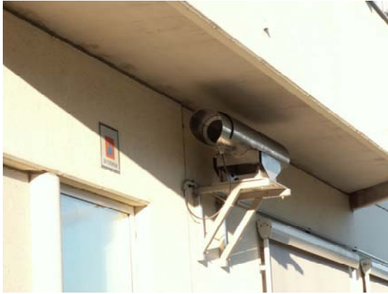
Bild 13. On-linemätning av luft i Jönköpings centrum (Kungsgatan). Data presenteras direkt på miljökontorets webbplats: www.jonkoping.se/mk/index.htm
