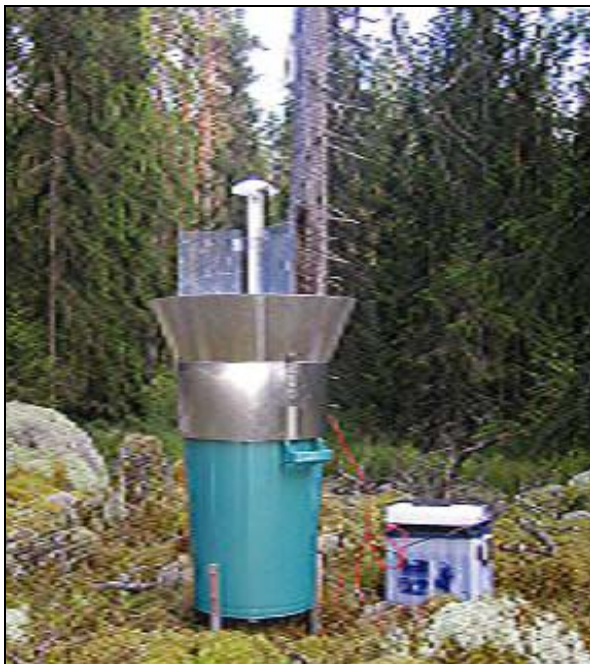
Bild 1. 12 V ljusfälla. Fällan på plats i fält – observera de tre plexiglasvingar som omger lysröret och som får fjärilarna att ramla ner i tratten. Foto: Hans Tingström
