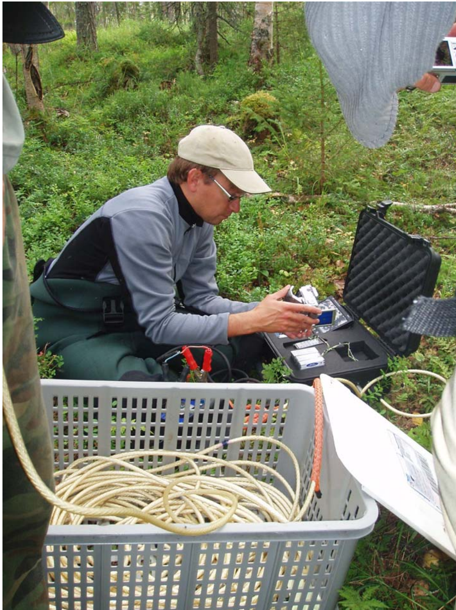
Figur 18. Till kameran tillhör 50 meter kabel för att kunna söka av djupa vatten eller större områden. Erik Årnfelt, Finska Lappland, Finland, augusti 2007. Foto: Jakob Bergengren.
