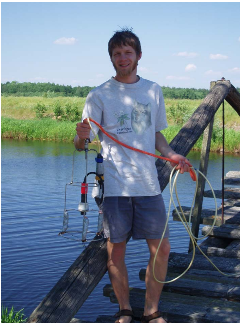
Figur 17. Själva kameran sitter i en skyddade bur som sänks ner i vattnet. Till denna hörde 50 meter kabel. Andreas Nilsson, Emån, Högsbyplatån, juni 2007. Foto: Jakob Bergengren.
