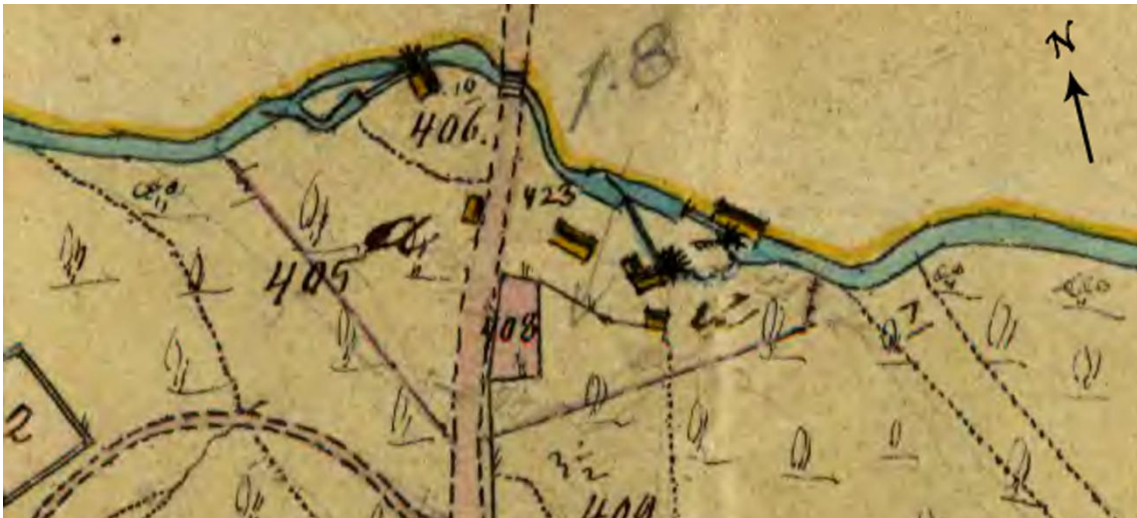
Utsnitt av karta laga skifte 1855 Fagerhult. Kartan visar en ansamling av kvarnar och sågkvarn längs Gagnåns fallsträcka där gamla vägen över Fagerhult och Karstorp passerar ån. Nr 423 vid Sågfallet anges på kartan som kvarnplats och längre nedströms har lantmätaren markerat sågkvarn. Lantmätaren har utritat hur drivvattnet har förts till anläggningarna. (Infälld N-pil).
