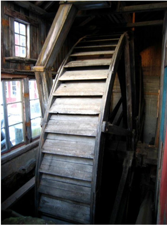
Det åtta meter i diameter stora vattenhjulet inbyggt i ett hjulhus, Bild till höger visar tillloppsränna (sump) med överfall till kvarnhjulet.
