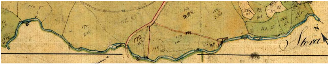
Utsnitt ur karta laga skifte 1833, Karshult. Lantmätaren har ritat in nio vattenhjul som markerar kvarnar och någon såg längs den 900 meter långa forssträckan vid Fagerhult. Nr 172 anges som sågplats där nu fastigheten Kvarnlieden finns. Nr 173 anges som kvarnplats. (Infälld N-pil).
