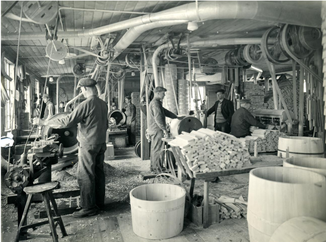
Interiör från Habo laggkärlfabrik år 1938. Här pågick tillverkning av laggade trätunnor. Maskinerna drevs av remtransmission från axelledning. Bild från Habo Släktforskarförenings arkiv.
