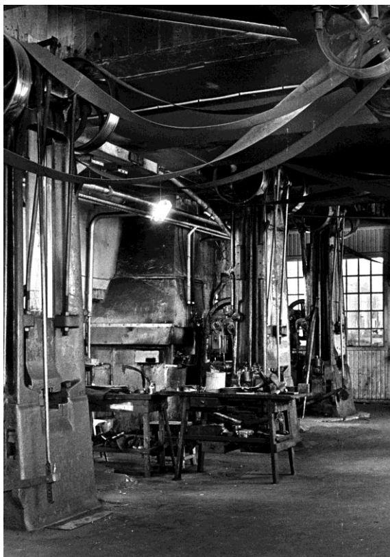
Hejarverkstad, Aledals nyckelfabrik. På 1970-talet Sveriges enda återstående fabrik av hejarsmida nycklar. Lägg märke till transmissionerna i taket. Industrin utvärderades som mycket värdefullt industriminne av stort teknikhistoriskt intresse av Julihn & Spade 1982, men den är nu borta. Foto troligen från 1970-talets förra del. Foto ur Bankeryds hembygdsförenings arkiv/Folkrörelsearkivet Jönköping.
