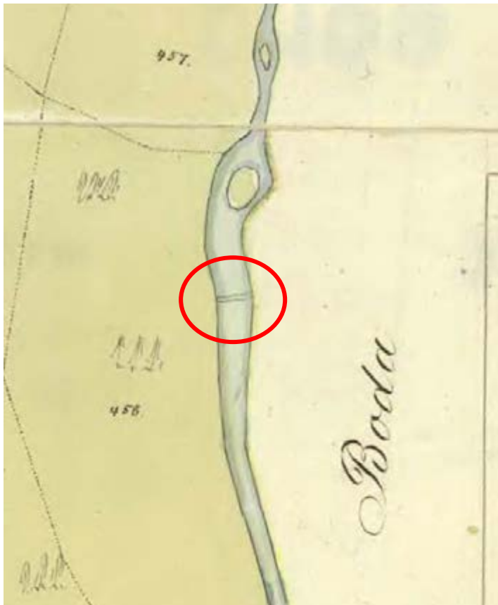
Fig 414. Sällevadsån 35 enligt äldre karta (akt E62-10:2, laga skifte år 1838). Dammen är markerad där ån gör en svag böjning åt söder, vilket motsvarar den exakta position där resterna av dammen påträffades.
