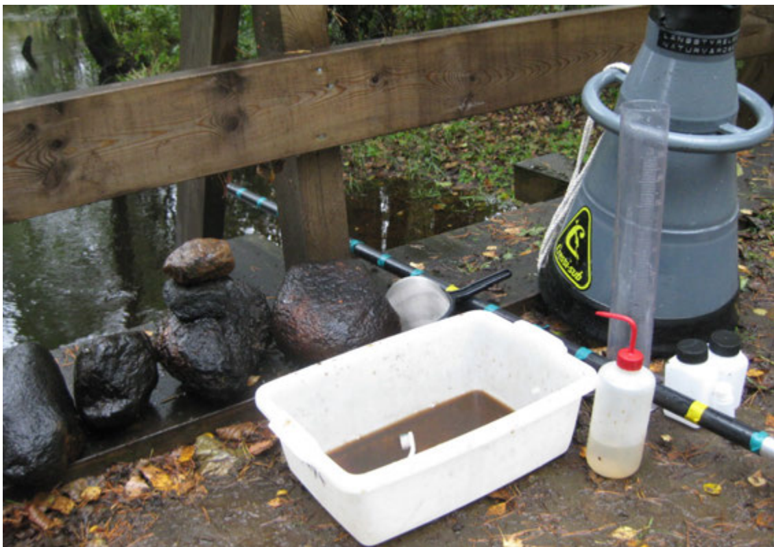
Bilden visar den utrustning som används vid provtagning av påväxtalger (kilselalger). Påväxtalgerna ger en bild av närings- och försurningspåverkan. Foto: Länsstyrelsens bildarkiv.
