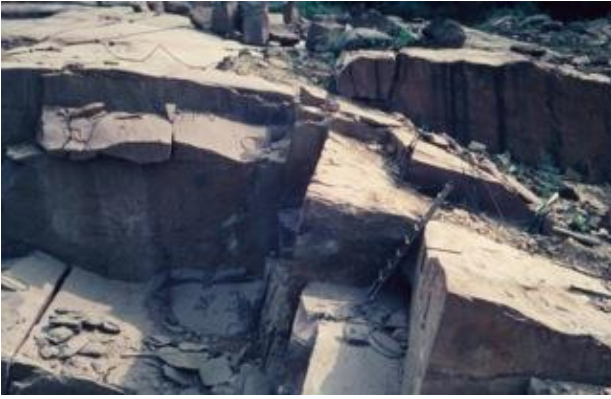
Fig. 3-2 Smålandsgranit med välutbildade spricksystem (Foto G. Knutsson 1972)
