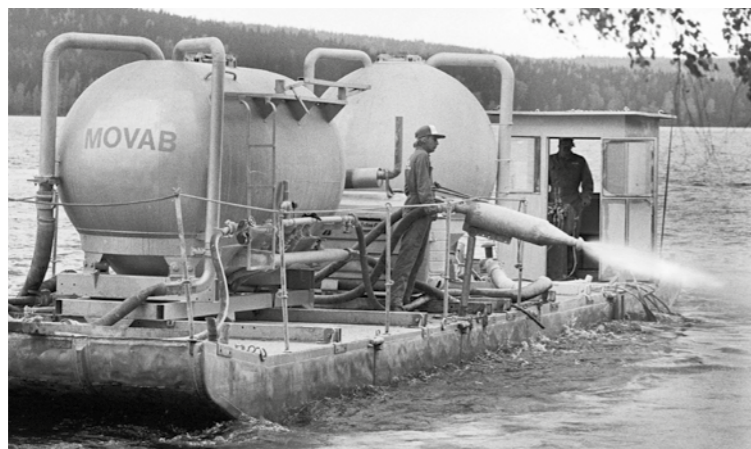
En av de första kalkbåtarna från början av 80-talet. Det var då kalkningen i Jönköpings län påbörjades i lite större skala. Foto: Kjell-Arne Larsson
