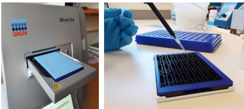
Bild 2. QiAcuity One systemet och den typ av 24-plattor som använts (Foto: Alizz Axberg©).
