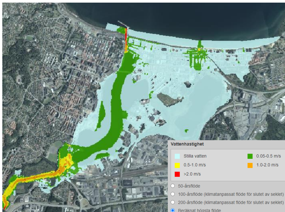
Figur 7. Karta över vattenhastighet i Tabergsån (genom Munksjön) till följd av beräknat högsta flöde (BHF).
