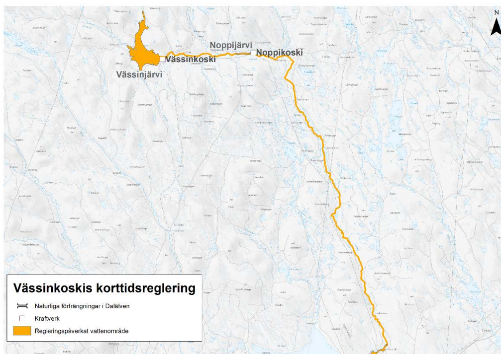
Figur 71. Kraftverk och magasin som direkt berörs av korttidsregleringen i övre delen av Ore älv.
