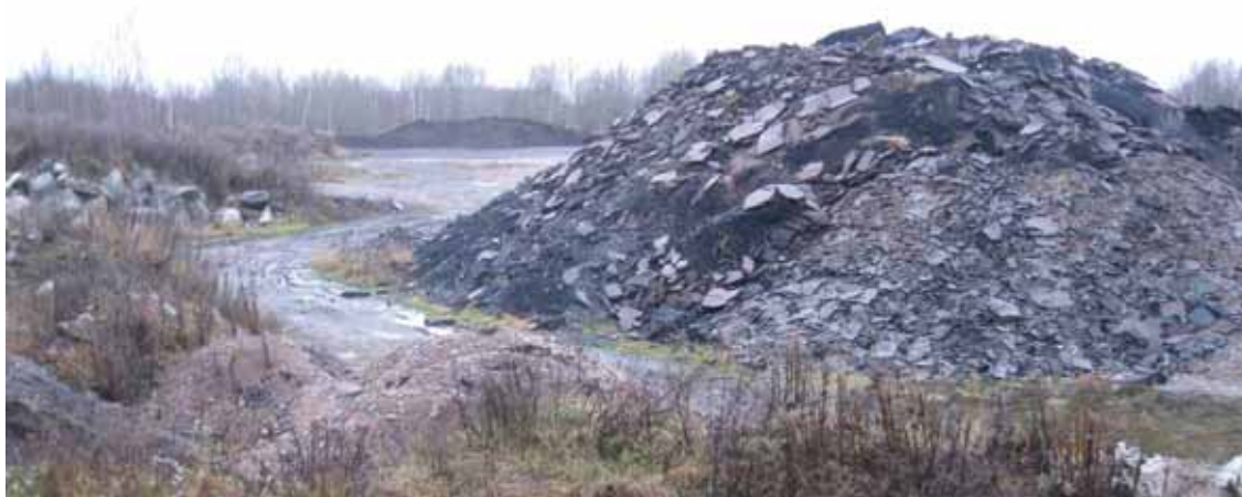
Uppsjötippen. Upplag av asfalt för återvinning.
