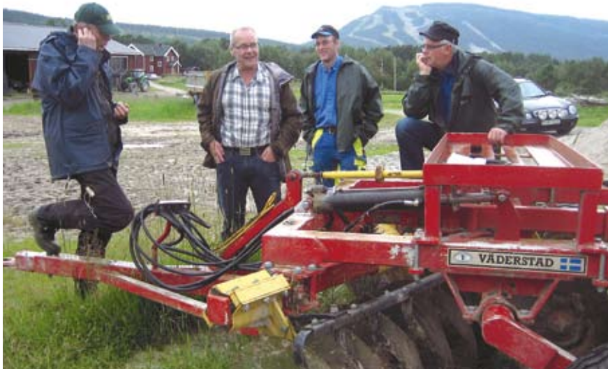
Tallriksredskapet använder Nils-Göran Nilsson innan plöjning vid vallbrott. Den gör ett bra jobb med att skära sönder vallsvålen.
