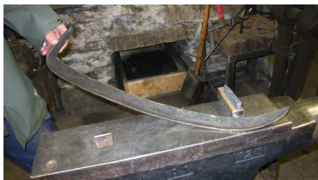
En färdig lie och vid liens spets en bit järn och stål som ska smidas ihop till en ny lie.
