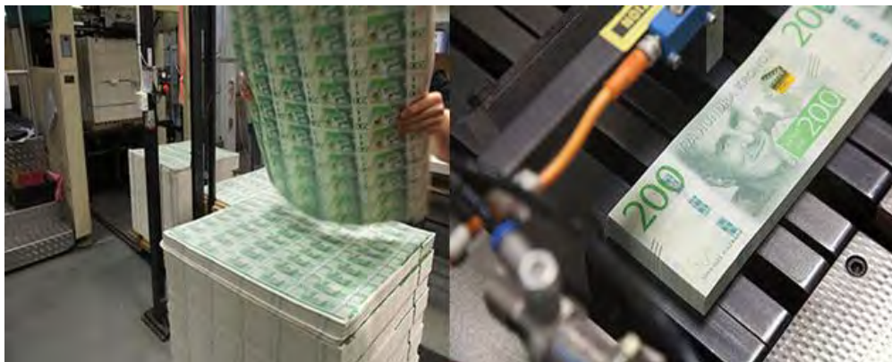
Luftning av ark och maskinell skärning av 200-kronors sedeln Foto: Riksbanken
