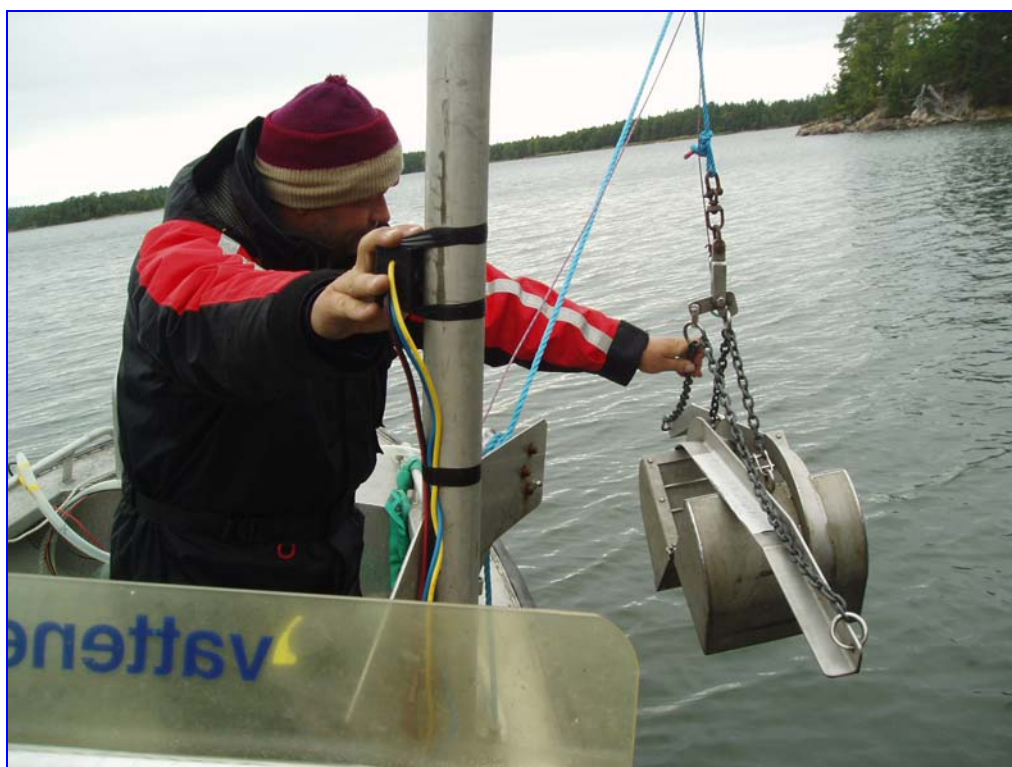
Figur 3-1. Van-Veenhuggare med kran användes för kvantitativ provtagning vid mjukbottenlokalerna.
