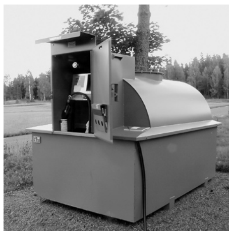
Cistern med diesel förvaras i en sk "miljölåda" med en invallningskapacitet på 100 %. Miljölådan, cistern och pump med pistolmunstycke är byggt i ett system. Bilden är tagen hos Säaw's Traktorgrävning
