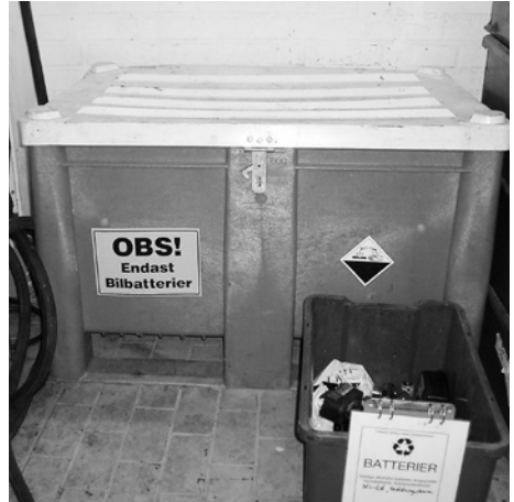
Bilbatterier som förvaras i syrafasta behållare. Bilden är tagen hos Tekniska Verken i Linköping AB.
