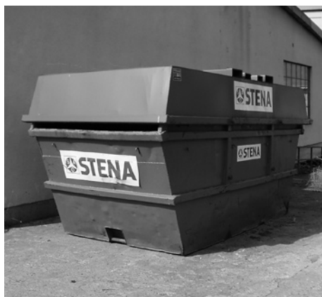
Container med lock. Lämplig för t ex oljehaltigt spån. Bilden är tagen hos Borggårds Bruk AB
