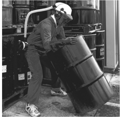
Att skydda sig själv är viktigt vid kemikaliehantering. Mannen på bilden använder andningsskydd i form av fläktmatat visir. Bilden kommer från Procurator AB.
