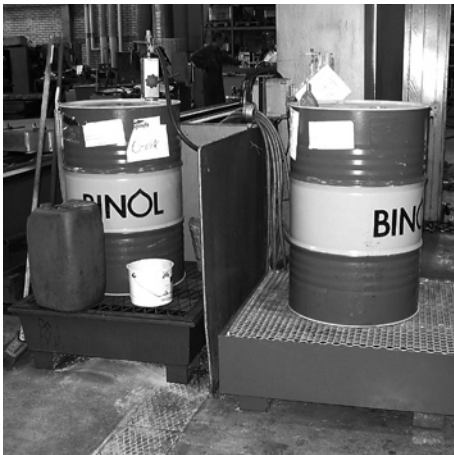
Kemikalie-loljeförvaring på gallerförsedda uppsamlingspallar. Dessa pallar finns i flera olika utförande både vad gäller material och storlek. Bilden är tagen hos AB Örnsköldsviks Mekaniska Verkstad.
