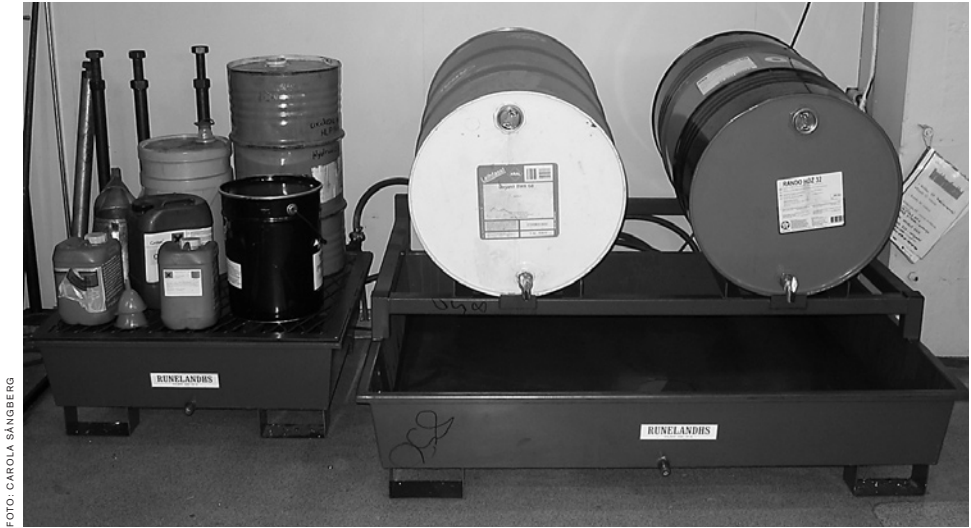
Kemikalielagring på uppsamlande kärl. Bilden är tagen hos AB Örnköldsviks Mekaniska Verkstad.
