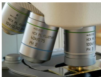
Figur 1. Kiselalgsanalys görs i ljusmikroskop i 1000 gångers förstoring med oljeimmersionsobjektiv. Mikroskopet ska helst vara utrustat med interferenskontrast, vilket gör att man kan se mycket små former tydligare än med andra tekniker.
