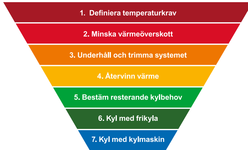
Figur 2 Beskrivning av arbetssätt för ett energieffektivt kylsystem.
