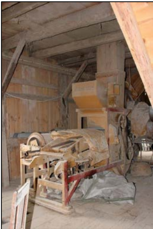
Bild 37 och 38. Triören, sorteringsmaskinen och mjölsäckar upphängda på lina intill denna. Foton: Helena Lundgren
