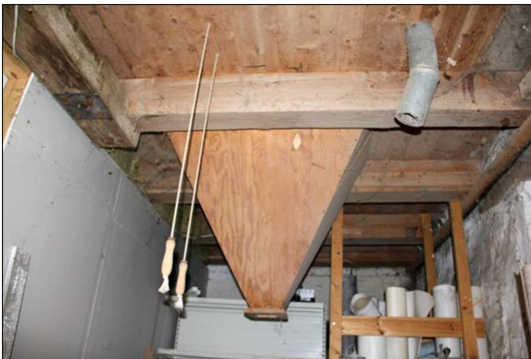
Bild 17. Tratt där säden kunde komma ned till ett av kvarnstenparen. Med snörena som hänger från taket kunde man antagligen styra flödet av säd från kvarnvinden. Foto: Helena Lundgren
