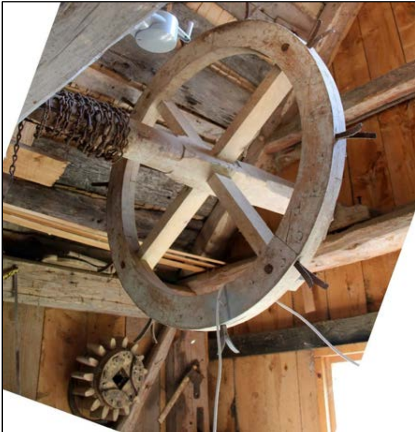
Bild 15. Bild av det hjul i trä vilandes på vindsbjälklaget möjligen till för att hissa sädessäckar. Foto: Helena Lundgren.
