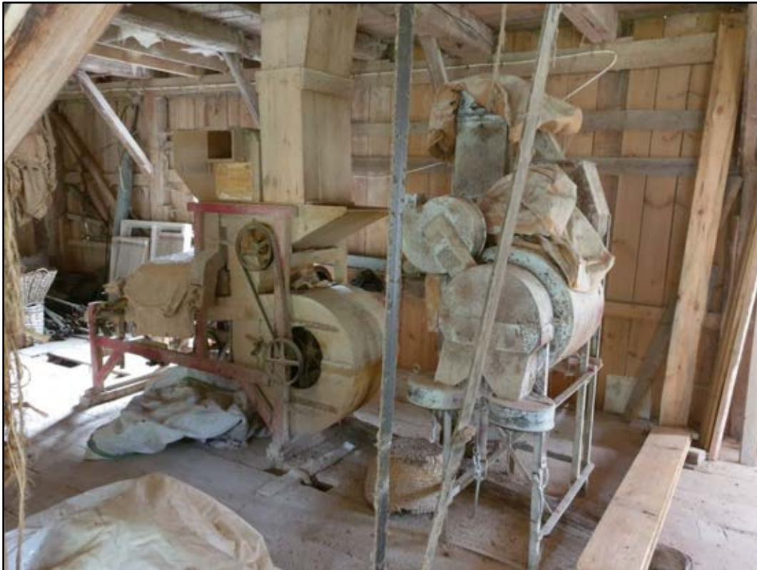
Bild 36. Sädeströr eller stiglufv t.v., där rensades och sorterade säd. T.h. står en betningsmaskin, där kvicksilvret blandades in. Foto: Eva Eliasson
