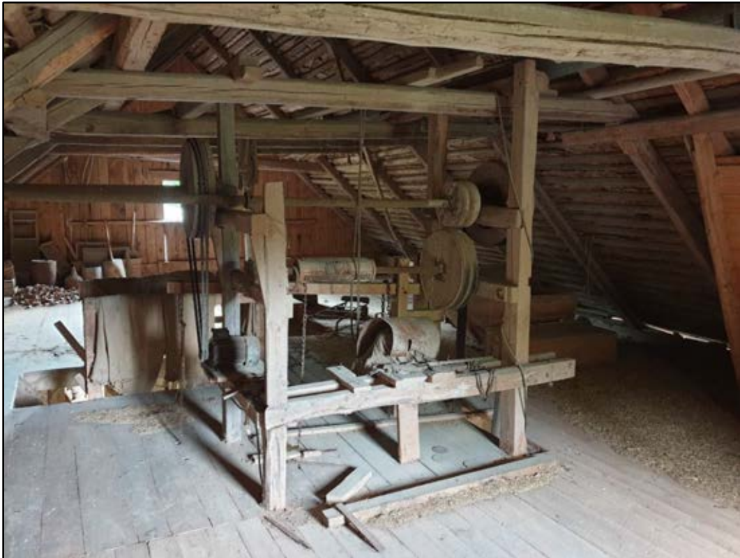
Bild 27. På vinden finns ett maskineri som som bl.a. använts för att hissa upp säckar. Foto: Eva Eliasson
