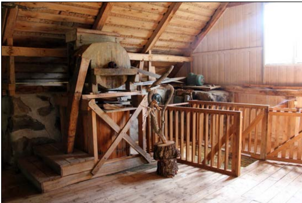
Bild 11. Maskinen är märkt Nirvana och har troligen använts som gröpkvarn. Stenarna är stående och finns i den runda delen som syns på bilden. På den delen står det 450 varv. Bakom den finns tratten där säden hälldes ned från den nu borttagna tredje våningen. Maskinen drevs av en motor via remmar, motorn syns vid gavelväggen. Under syns en trätunna som är den övre delen av den mjölblandare som finns på bild 10. Maskinen är förmodligen levererad av Bronäs Kvarnfabrik, Vinninga. Foto: Helena Lundgren
