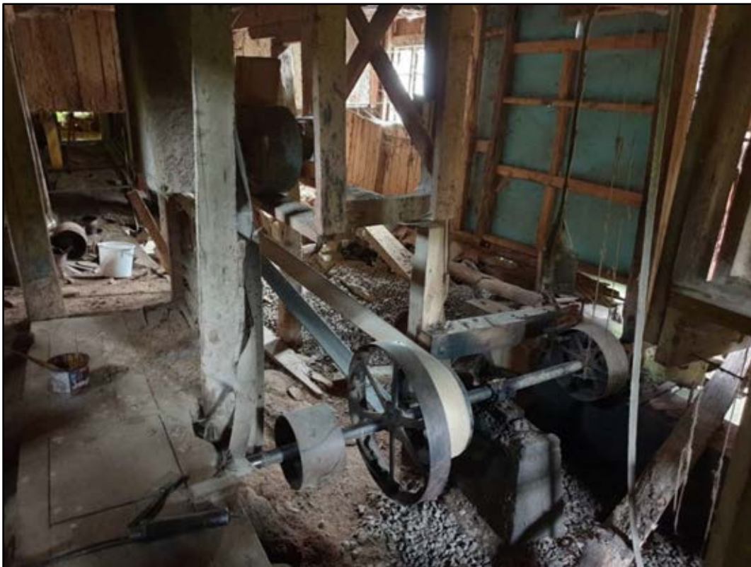
Bild 52. Bilden visar remdriften som leder kraften från kvarnens turbiner till sågen. Foto: Eva Eliasson
