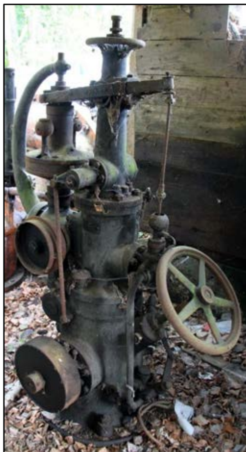
Bild 23, 24 och 25. Turbinregulator av märket Werkstaden Kristinehamn, enligt skylten tillverkad 1911. (1859-1897, 1897 förvärvat av Karlstads Mekaniska Werkstad). Foto: Helena Lundgren.
