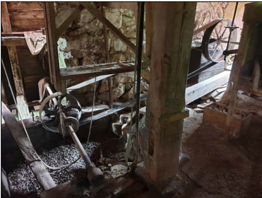
Bild 50. Här går remdriften i kvarnens grund, även kallad nedre botten. Foto: Eva Eliasson.
