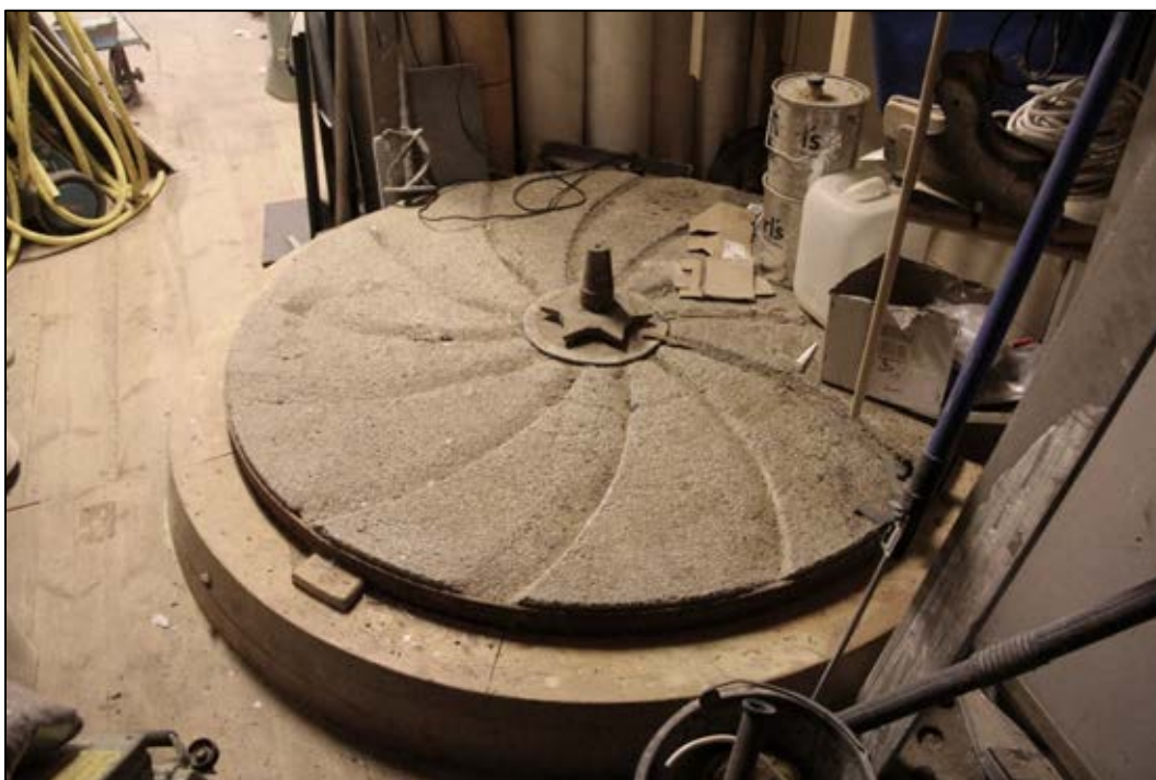
Bild 18. Delar av det ena kvarnstensparet finns kvar, detta är liggaren, löparen som legat ovanpå finns inte kvar. Foto: Helena Lundgren
