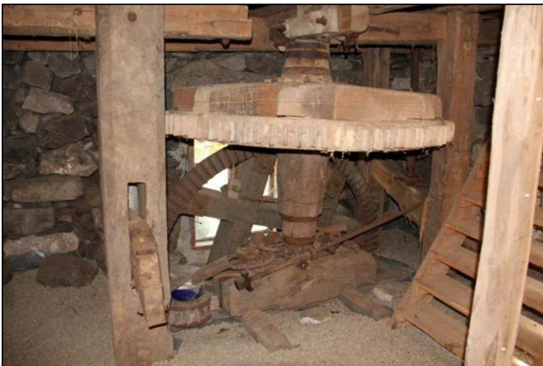
Bild 14. Ännu en bild av det horisontalt liggande kuggjul i trä som överför kraften från vattenhjulet. Foto: Helena Lundgren.
