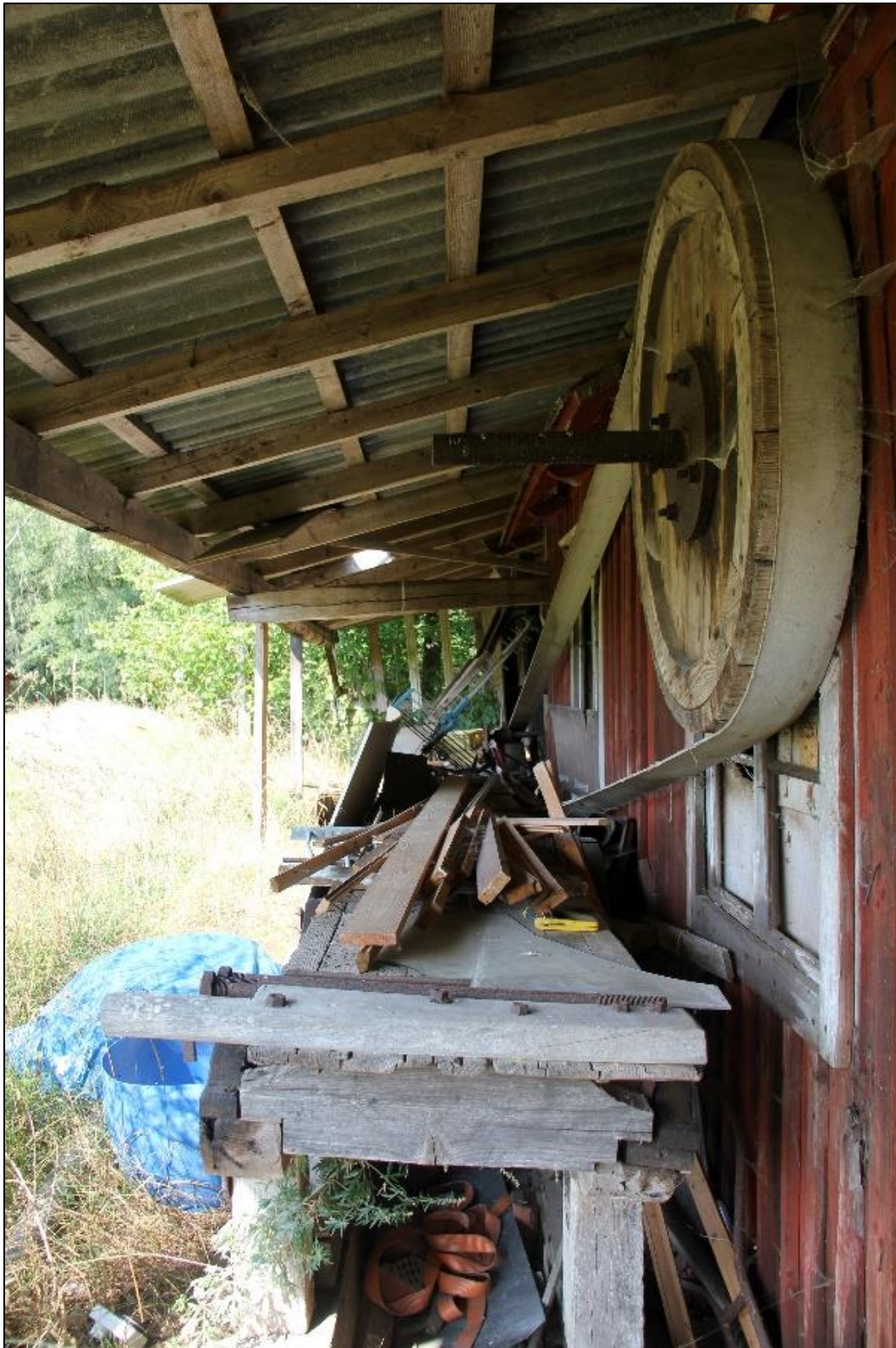
Bild 3. Såglinjen med sin remdrift. Bilden tagen mot norr. Foto: Helena Lundgren
