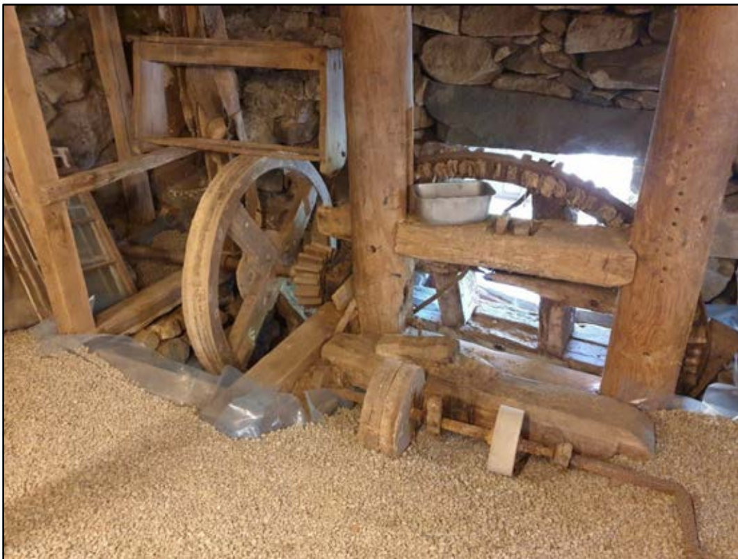
Bild 12. Interiör från västra kvarnen. Vertikalt sittande kugghjul, ett s.k. gravhjul eller krontrev, som tidigare överfört kraften från vattenhjulet, i den nedre delen av kvarnen med murade väggar. Till vänster syns ett av hjulen till anläggningens remdrift. Foto: Eva Eliasson.
