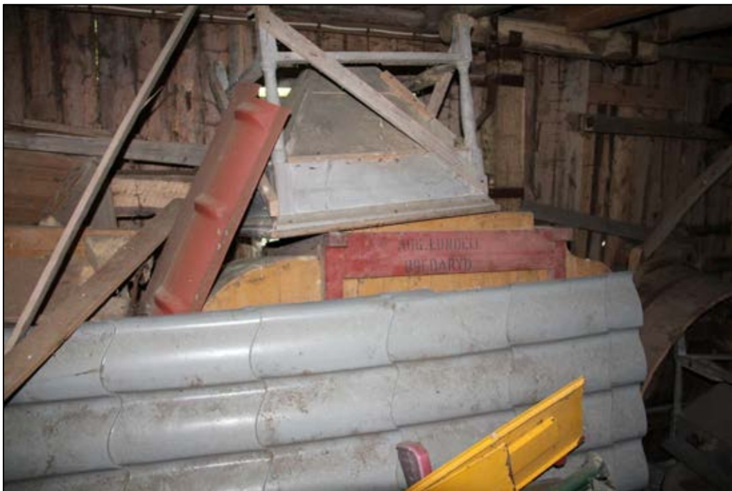
Bild 9. Till vänster om kvarnkaret och bakom takplåten syns delar av en rensmaskin, även kallad sädesharpa, levererad från August Lundell i Bredaryd. Ovanpå ligger en av sädestrattarna till ett kvarnstenspar. Foto: Helena Lundgren
