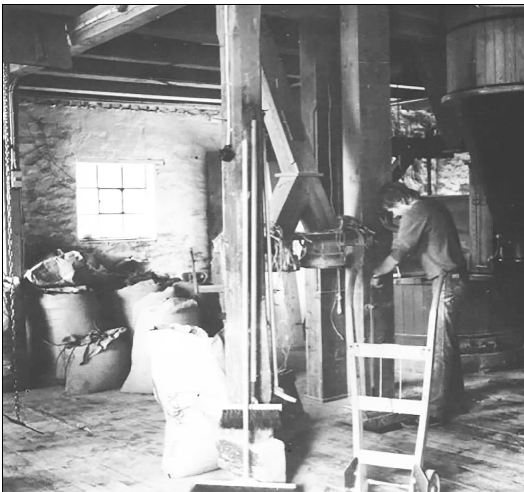
Historisk bild 9. Interiörbild från kvarnen. Mannen på bilden står vid mjölkastet där säckarna fylls på med det nymalda mjölet. Bilden är troligen tagen 1991. Foto: ur Tidsbilder I, 1991, artikel om Lennart Johansson, s. 81
