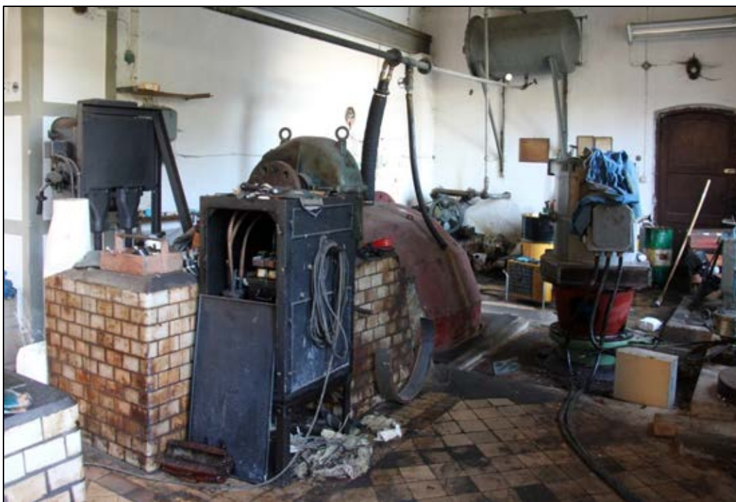
Bild 23. Längst in i byggnaden och längst söder ut stod den tredje pumpen, idag bara delar kvar av den samt dess fundament. Till höger syns den nya pumpen. Foto: Helena Lundgren
