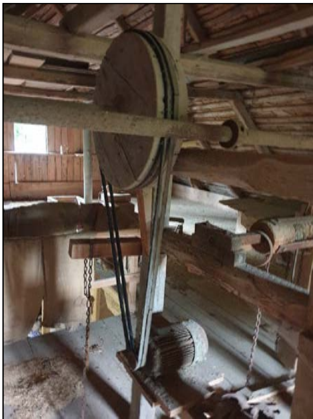
Bild 28. En motorn driver lyftanordningen som hissar upp mjölsäckarna. Foto: Eva Eliasson
