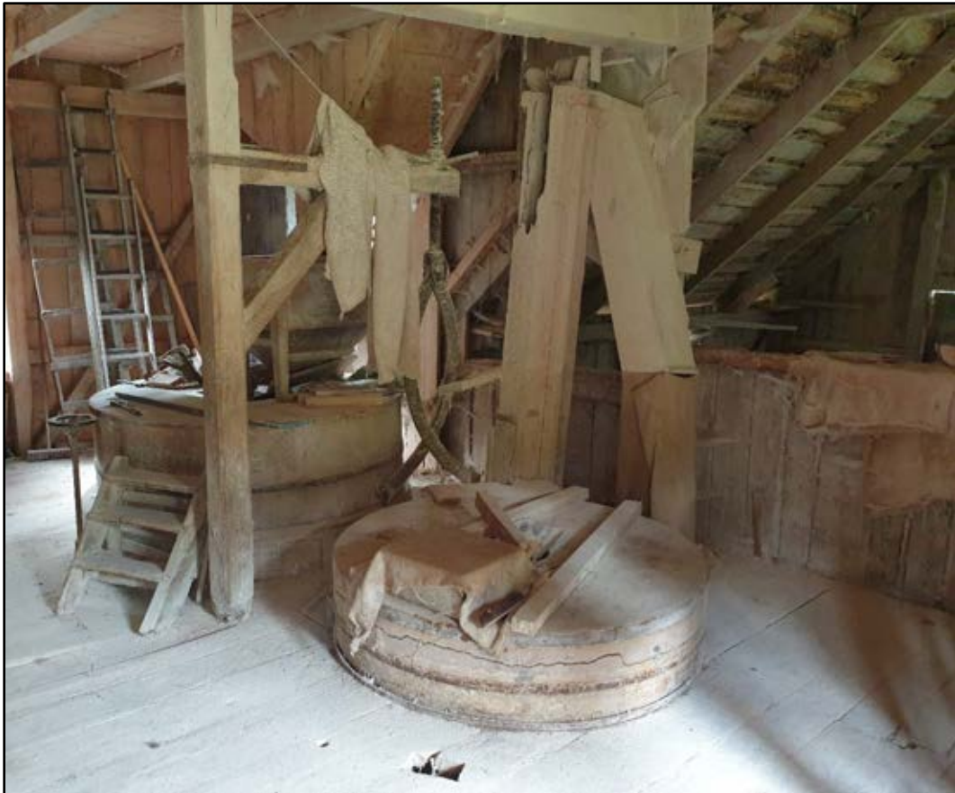
Bild 31. Här syns själva kvarnen. I det kvarnkar som är komplett finns kvarnstenarna som malar säden till mjöl. Till vänster syns ratten till lättverket för att justera mellanrummet mellan kvarnstenarna. Mellan dessa finns en stensax. Foto: Eva Eliasson.
