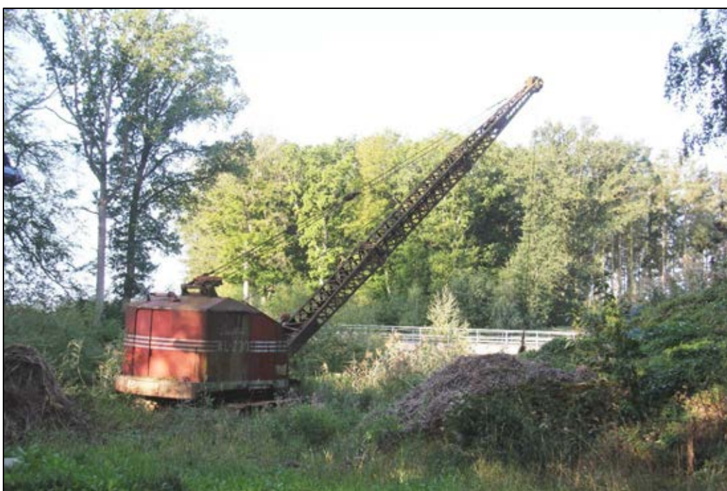
Bild 12. Invid ån står den här lingrävaren som används vid vassröjning. Längs fram på armen sitter en vajer med en gripklo längs ned med vilken det går att lyfta upp vass från vattendraget. Till höger i bild syns en mindre kulle som består av upptagen vass. Bilden tagen mot sydväst. Foto: Helena Lundgren
