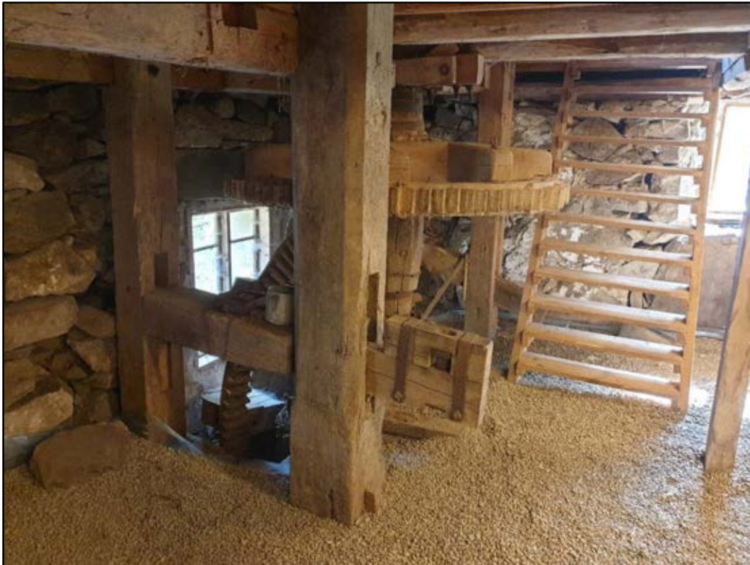
Bild 13. Bild av ytterligare ett gravhjul och horisontalt liggande kuggjul i trä som överför kraften från vattenhjulet, öppningen nu igensatt med fönster. Troligen ett lättverk i förgrunden som tidigare användts för att starta vattenhjulet med och därmed hela kvarnverket. Foto: Eva Eliasson.
