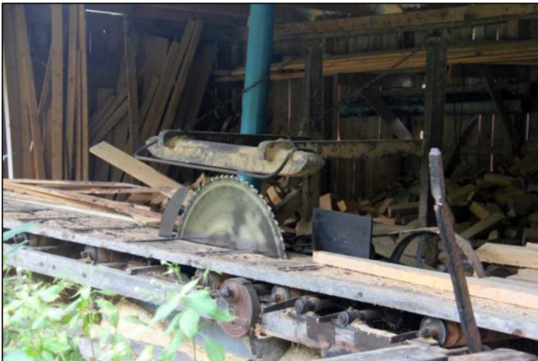
Bild 48. Cirkelsågens sågklingan i närbild på sågbänken. Klingskyddet syns ovanför. Foto: Helena Lundgren
