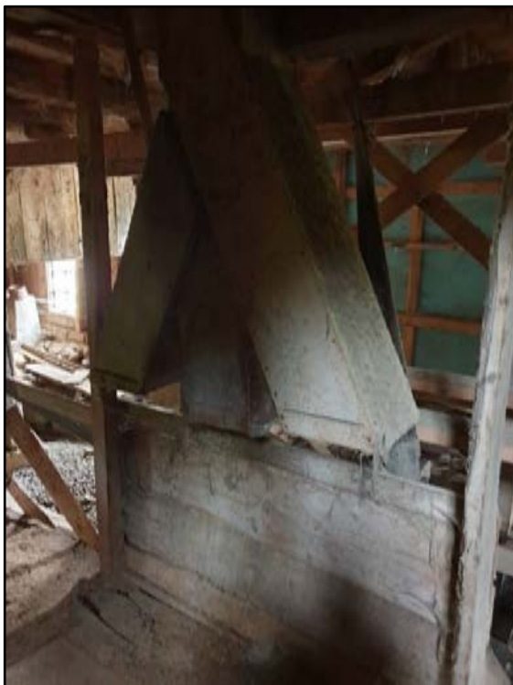
Bild 41. Under kvarnen finns trummor från krossmaskinen där agnarna och allt äkte ner vid krossning av säd till djurfoder. Foto: Eva Eliasson
