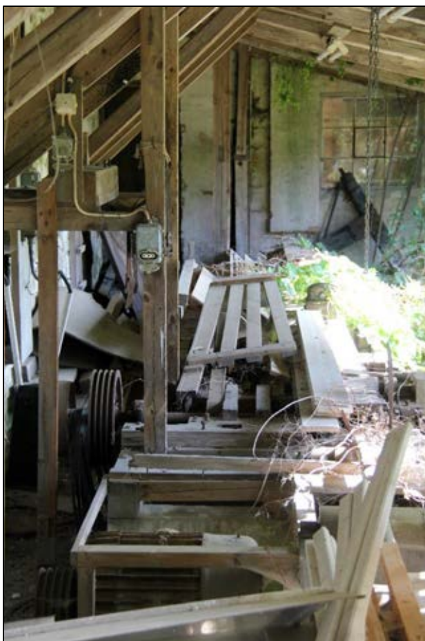
Bild 4. Interiör från det öppna såghuset. På bilden syns delar av remdriften. Bilden tagen mot öster. Foto: Helena Lundgren
