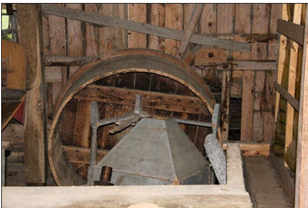
Bild 7. Mot väggen lutar det ena kvarnkaret. Framför syns den ena sädestratten till kvarnstensparet som ligger på golvet under sädestratten. Foto: Helena Lundgren
