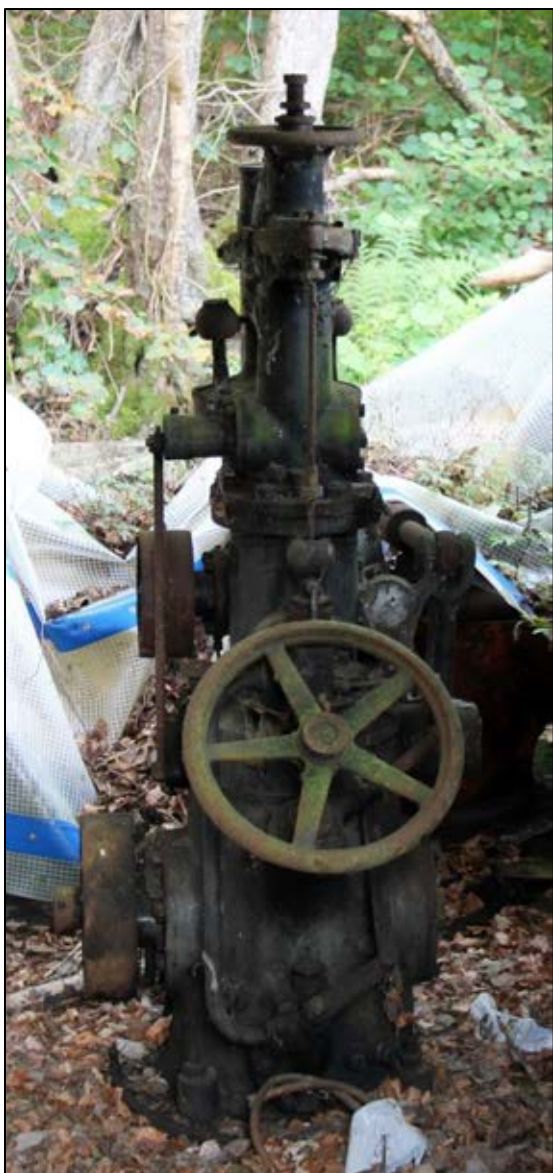
Bild 23, 24 och 25. Turbinregulator av märket Werkstaden Kristinehamn, enligt skylten tillverkad 1911. (1859-1897, 1897 förvärvat av Karlstads Mekaniska Werkstad). Foto: Helena Lundgren.
