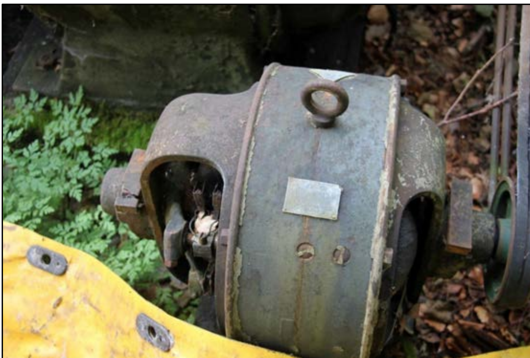
Bild 34. Delen som är tillverkad av Luth & Roséns Elektriska Aktiebolag är möjligen en likströmgenerator, vilken är sammankopplad med generatorn genom remdrift. Foto: Helena Lundgren.
