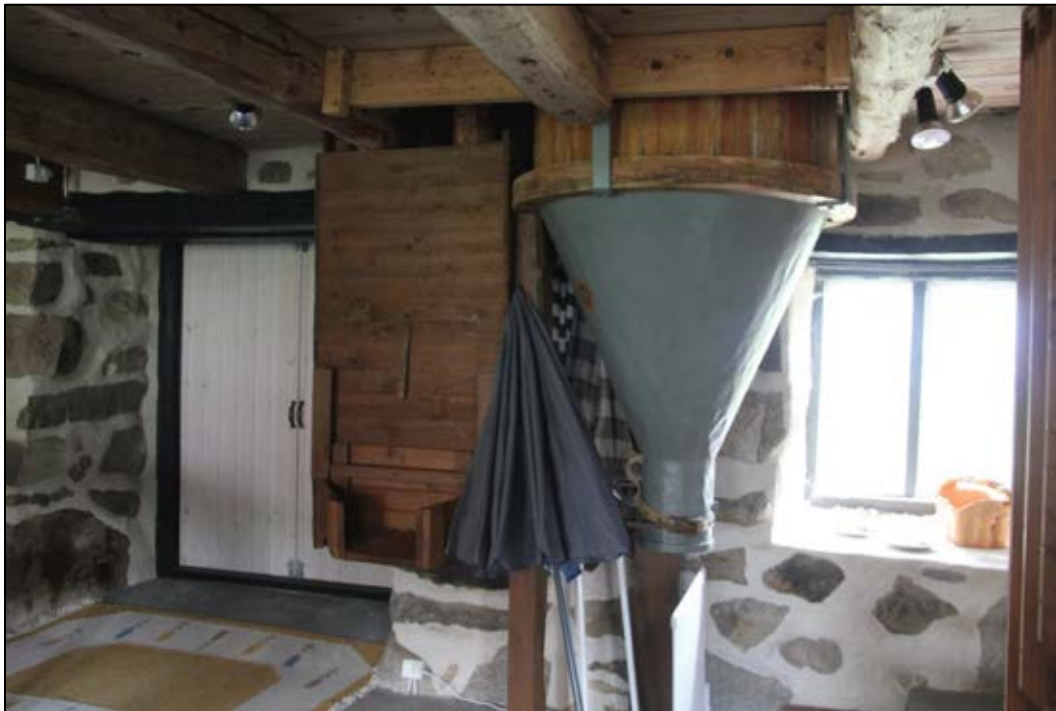
Bild 10. Söder om den östra entrédörren finns den här tratten av plåt. Det är en mjölblandare som är märkt President, Paul Diness Maskiner. Nertill finns en läderrem och med hjälp av den gick det att spänna fast en mjölsäck. Foto: Helena Lundgren
