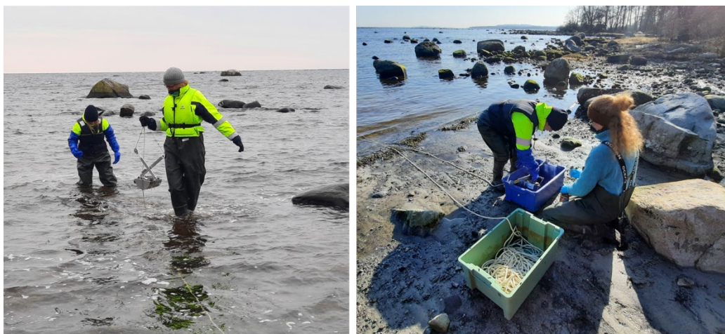
Figur 2. Provtagning av sediment med hjälp av Van Veen huggare i grunda havsområden. På bilderna från höger Greta Gustafsson och Lisa Winberg von Friesen, IVL. Foto: Maria Granberg
