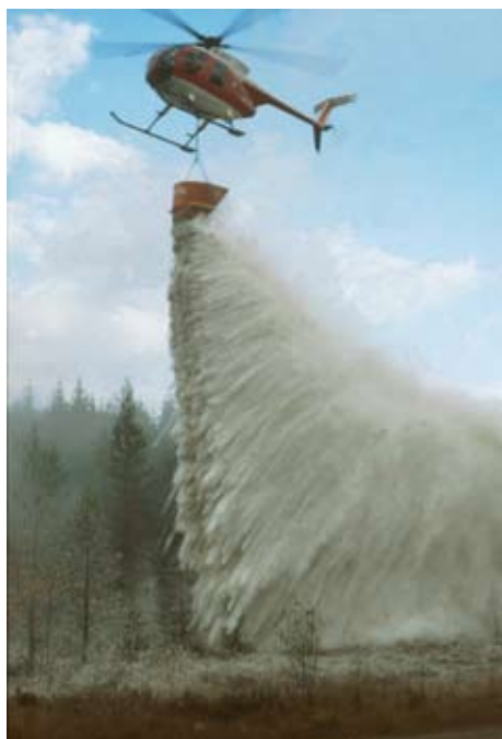
Spridning av kalk över sjöar och våtmarker med hjälp av helikopter. Foto: Lars Möller.
