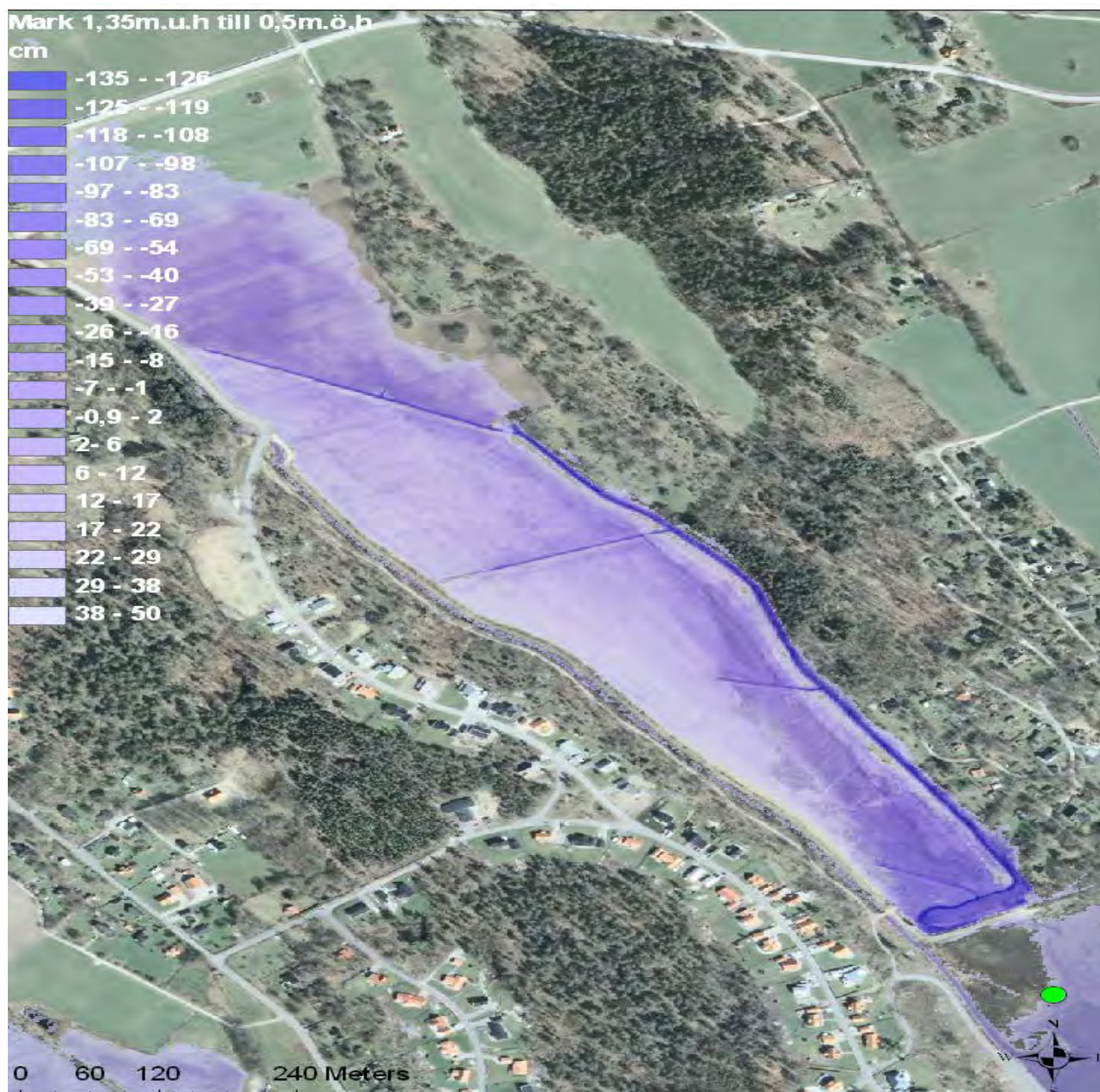
Figur 2. Ortofoto över Grönadals invallningsområde. Den blå färgen anger nivån i cm i förhållande till havsytans nivå, upp till + 50 cm. Den gröna punkten är en referenspunkt som används för att jämföra olika kartor.
