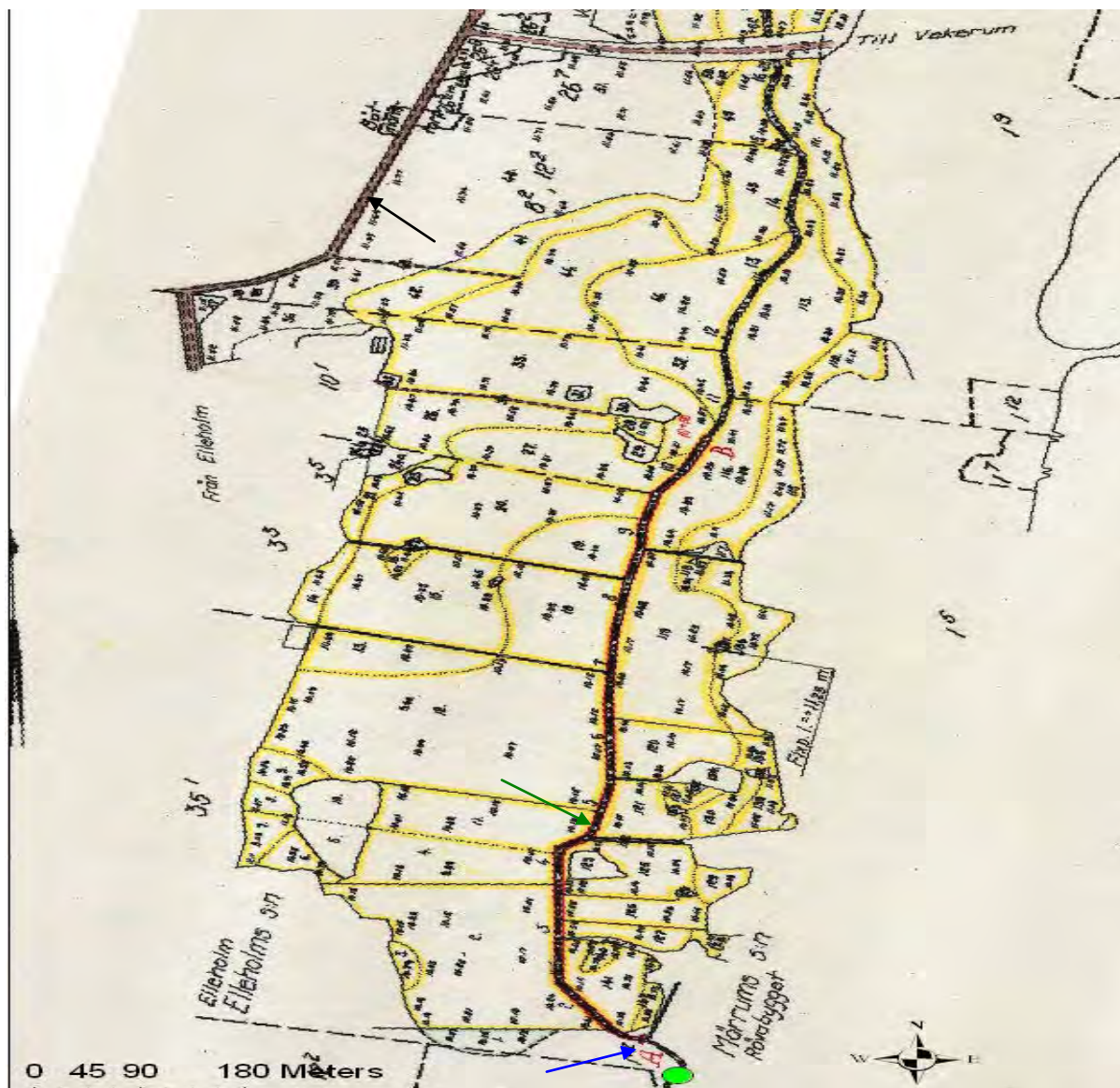
Figur 14. Dikningskartan från år 1962 gjordes i samband med byggandet av massafabriken Mörrums bruk. Pumphuset finns vid punkten A på kartan, blå pil. De gula områdena är åkermark och det gröna området är ängsmark. Den gröna pilen visar placeringen av det öppna diket. Den gröna punkten är en referenspunkt som finns även i övriga kartor från detta område.
