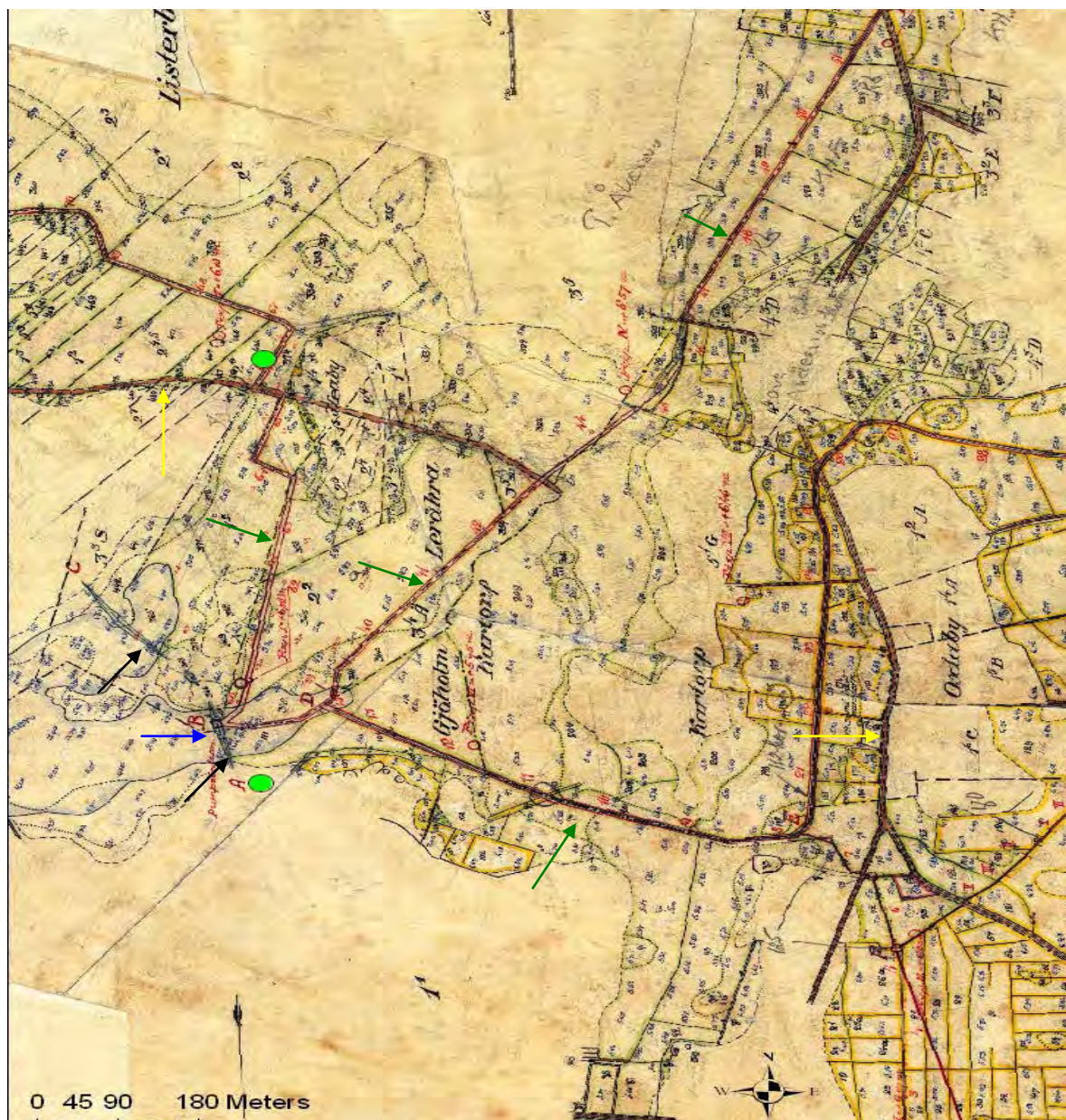
Figur 30. Invallningskarta från 1948 som visar de planerade åtgärderna inom invallningsområdet Göholm. Den svarta pilen visar läget för vällen, den blå pilen visar var pumphuset skulle placeras, gula pilar visar vägarna som går igenom området och gröna pilar indikerar läget för de öppna diken. Gula områden är åkermark, blå områden är öppet vatten och gröna områden är ängsmark/översvåmningsmark. De gröna punkterna är referenspunkter som finns även på övriga kartor från detta område.
