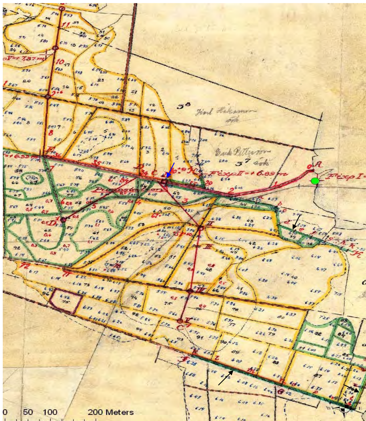
Figur 67. Invallningsområdet Stålemara-Olsång. De dubbelsträdda röda linjerna är öppna diken. Röda ringar visar var dagvattenbrunnar anslades, enkla röda linjer visar rörledningar och gröna linjer (från I-L, B-H och B-L) indikerar vallar, se svarta pilar. Pumpen anslades vid punkt B, se blå pil. Gula streck visar åkermark och övriga gröna streck indikerar antingen skog eller betesmark. Den gröna punkten är en referenspunkt som finns även på övriga kartor från detta område.
