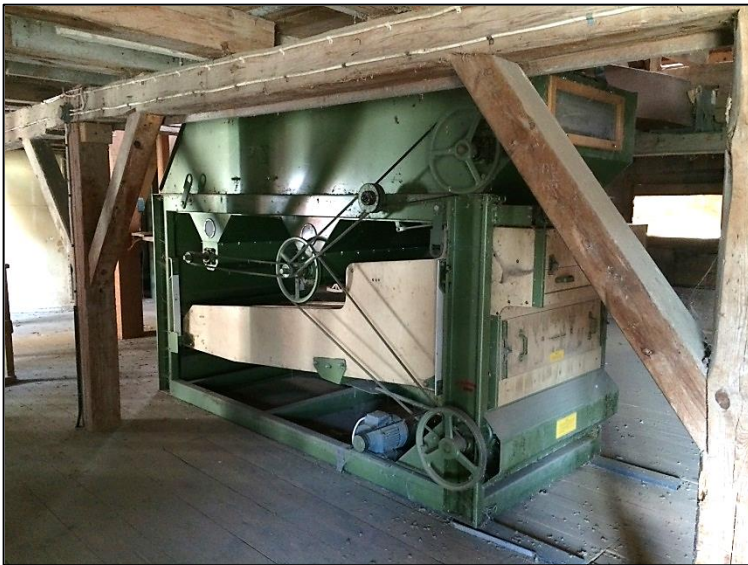
Bild 6. Rensmaskin i tröskverksbyggnaden.
