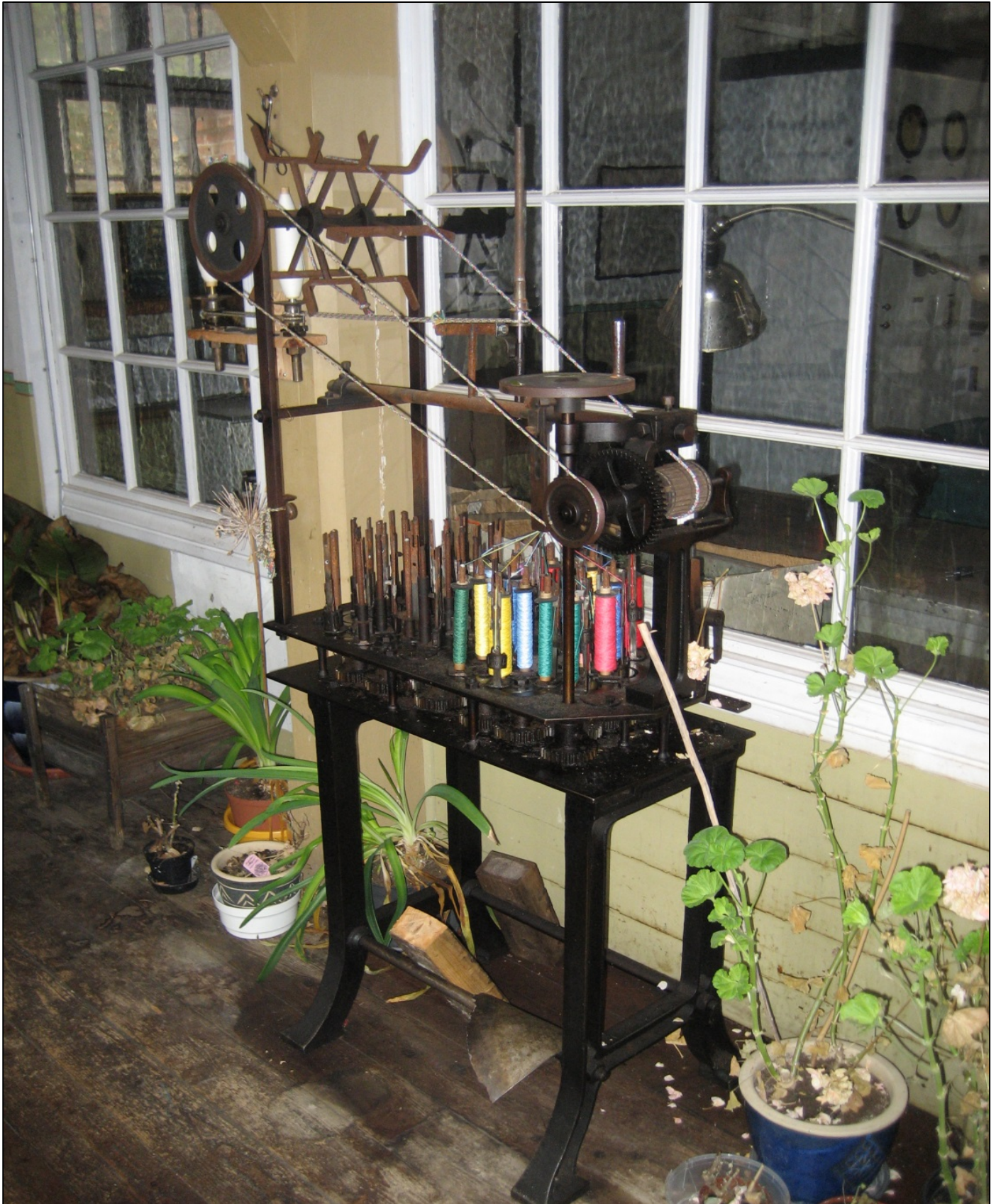
Bild 9. Den sinnrika trådrullemaskinen, där 32 stycken trådrullar kunde tillverkas samtidigt. Foto: Petra Stråkendal.
