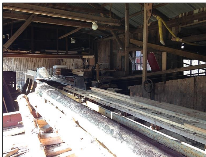
Bild 3. Interiört i sågverksbyggnaden, med ramsåg och annan utrustning.
