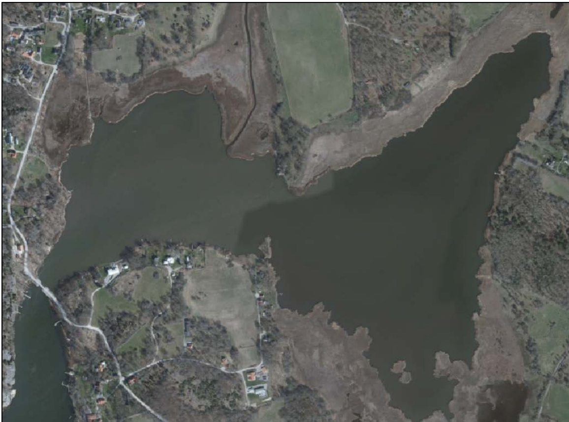
Figur 32. Nordsjön fotograferad 2016, med tydlig påverkan av grumligt vatten från Lillån och av vägbankens begränsande effekt på vattenutbytet i vikens västra del.
