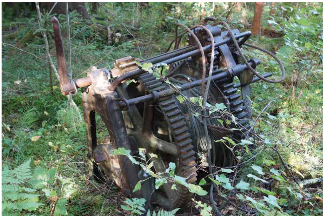
Fig. 72. Järnspelet, vaderspel (60) till flottningen. Spelet är fastsatt i marken intill ån.
