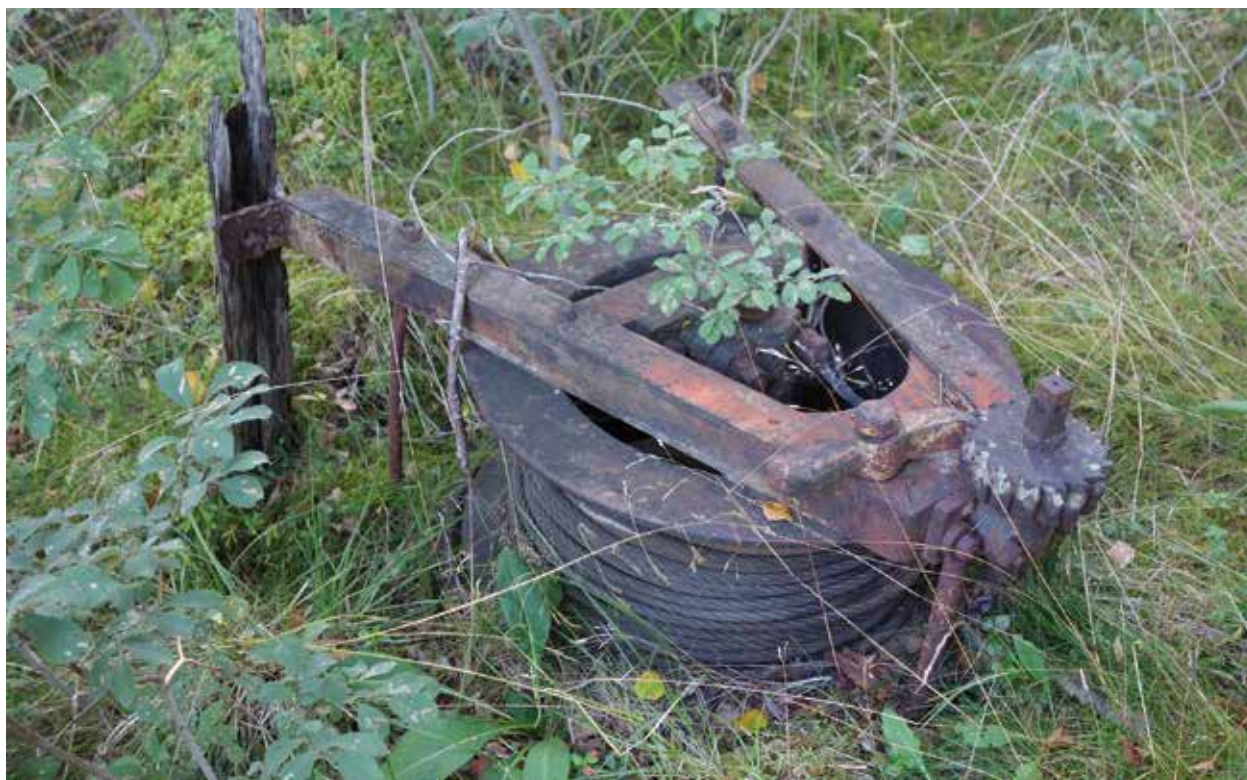
Fig. 55. Järnspel till flottningen (30), fastsatt i marken.
