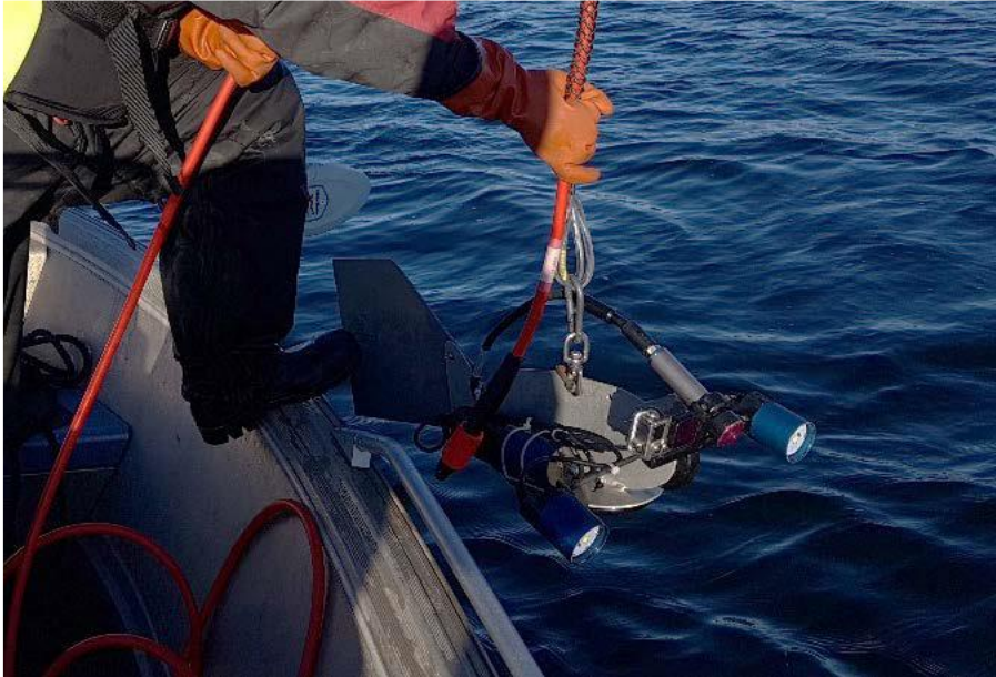
Figur 2. Videosystem som användes vid karteringar längs Gotlands nordvästra kust 2018.
