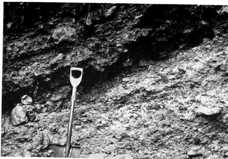
Bild G32. Grusmaterial, sammankittat av utfälld kalk. 500 m sydväst om Broträsk, STÅNGA, objekt 63:G5
