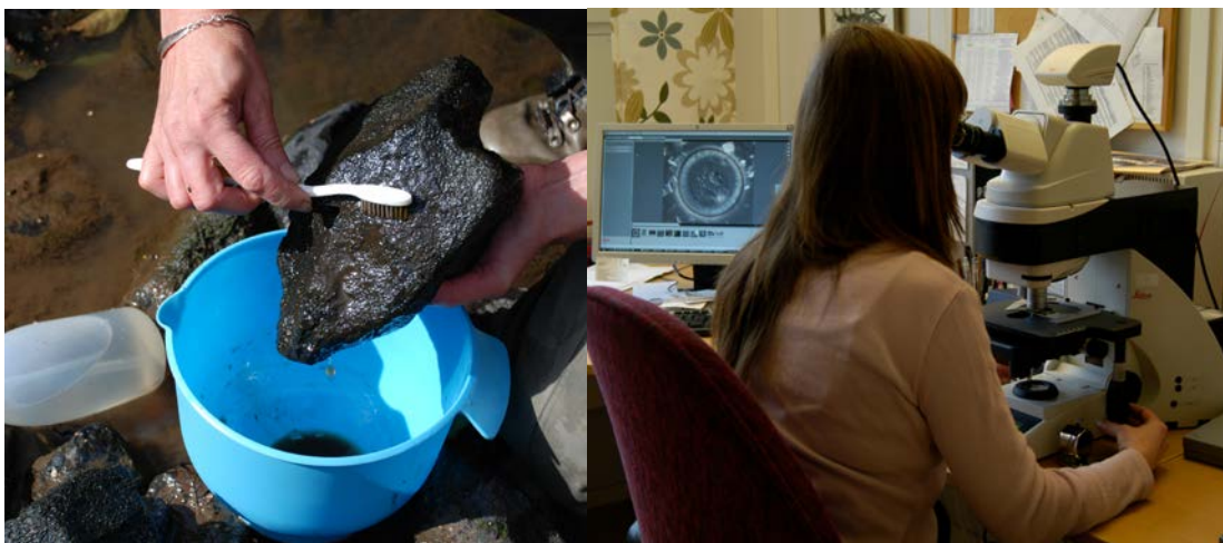
Figur 2. Kiselalger insamlas i första hand från stenar. Ovansidan borstas ordentligt med en ren tandborste, varefter stenen sköljs av med åvatten och påväxtmaterialet samlas upp. Analysen görs i ljusmikroskop i 1000 gångers förstoring med oljeimmersionsobjektiv. Mikroskopet ska helst vara utrustat med interferenskontrast, vilket gör att man kan se mycket små former tydligare än med andra tekniker, © Medins Biologi AB.
