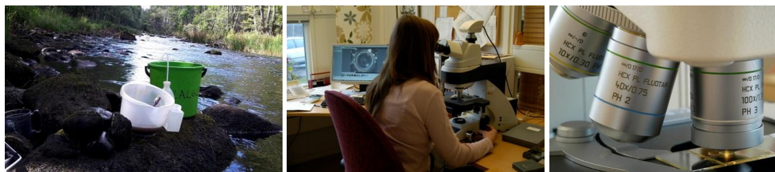
Figur 1. Kiselalgsanalys görs i ljusmikroskop i 1000 gångers förstoring med oljeimmersionsobjektiv. Mikroskopet ska helst vara utrustat med interferenskontrast, vilket gör att man kan se mycket små former tydligare än med andra tekniker.
