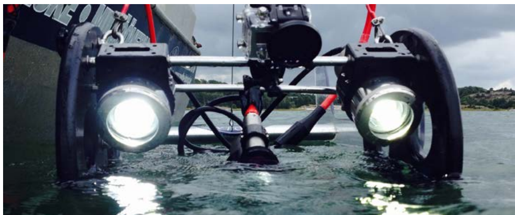
Figur 2. Videosystem som användes vid karteringar längs Gotlands nordvästra kust 2017.
