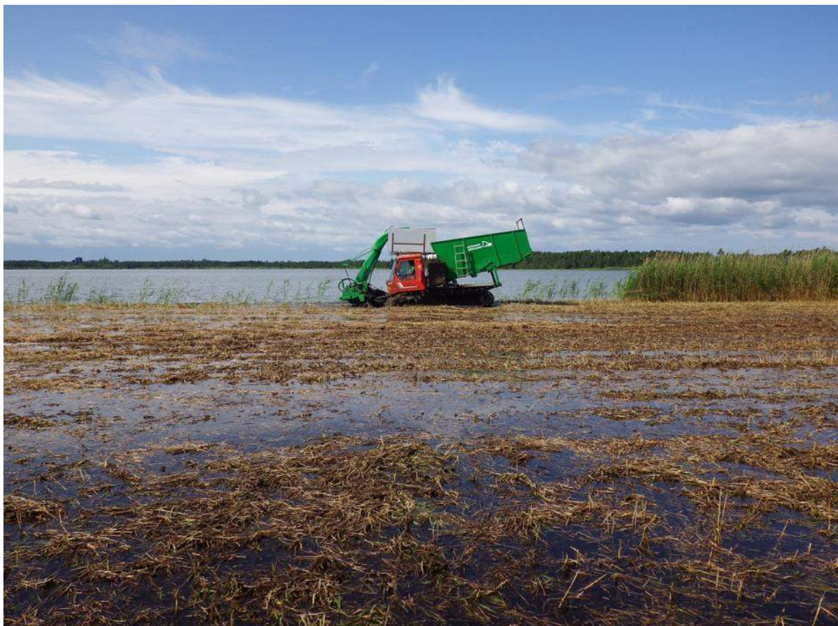
Figur 6. Vattennivån på strandängen i Boge Viken följer havets nivå och maskinen fungerar bra i vattendjup ner till 20-30 cm.
