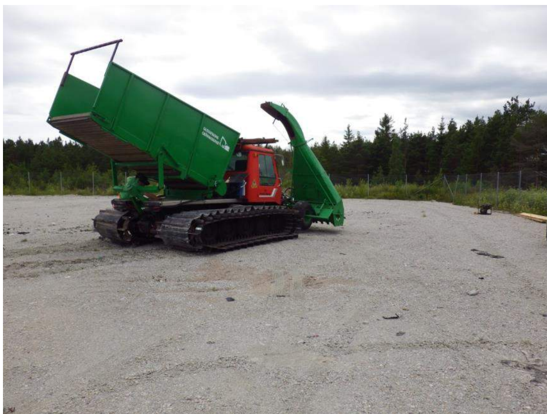
Figur 2. En av de maskiner som användes vid klippningen, en ombyggd pistmaskin.
