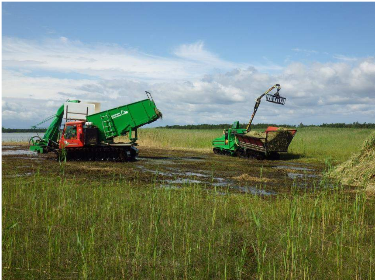
Figur 8. När containern i pistmaskinen är full töms den antingen på marken eller direkt i bandvagnens behållare.
