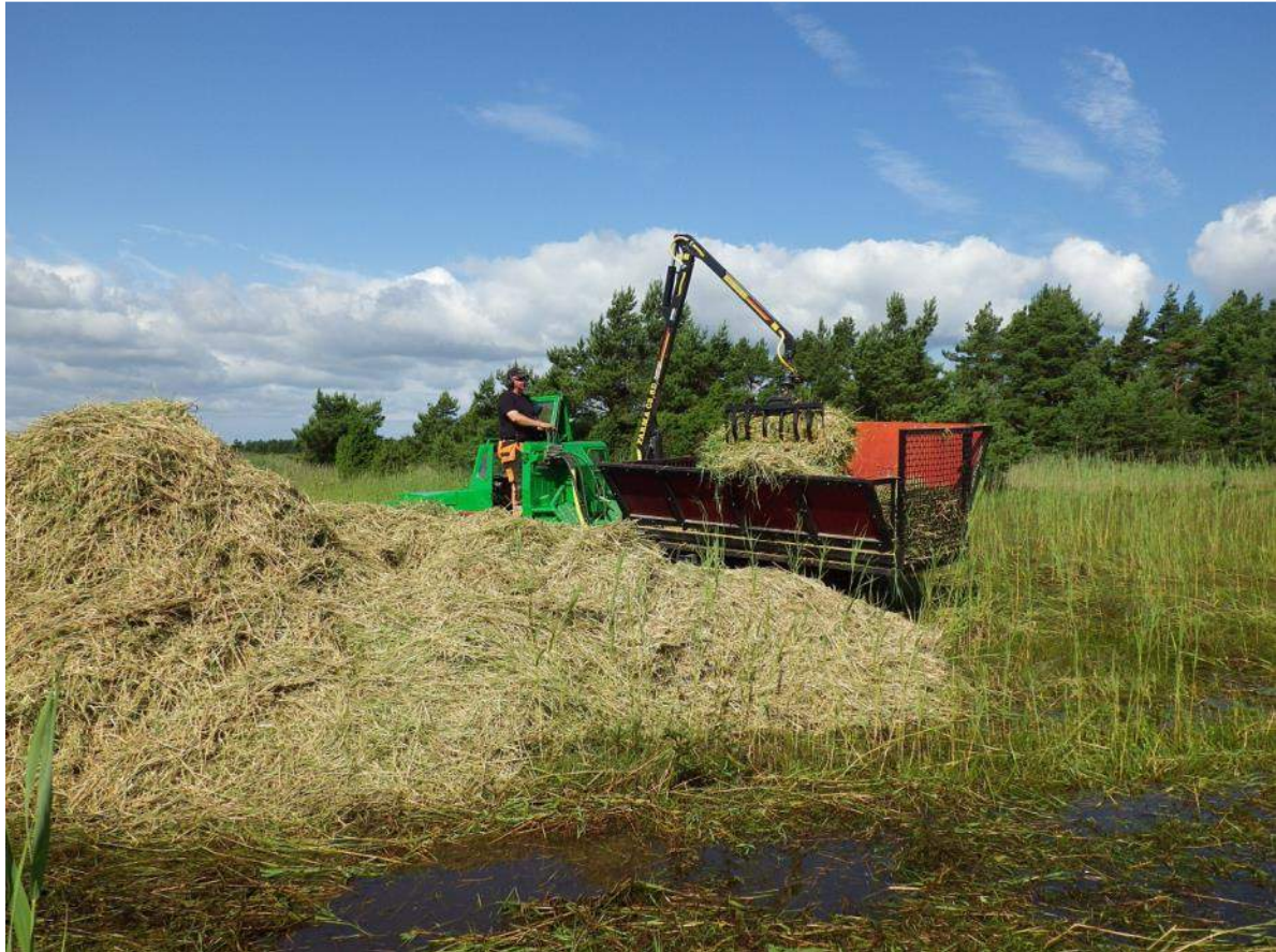
Figur 9. Med hjälp av bandvagnens griparm lastas den klippta vassen i den specialbyggda vagnen och transporteras därefter bort från strandängen.
