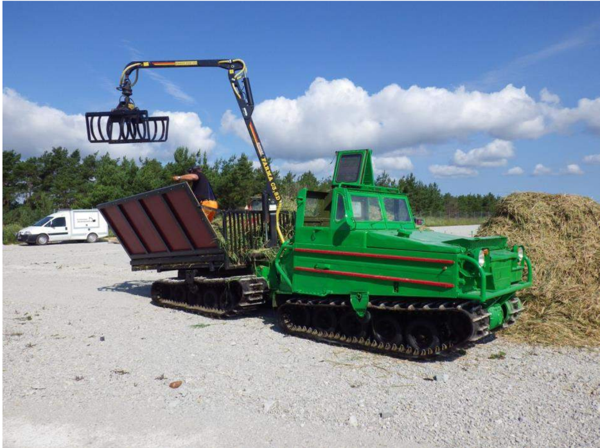
Figur 7. Uppsamlingen av den klippta vassen och närtransporten från strandängen sker med en modifierad bandvagn.
