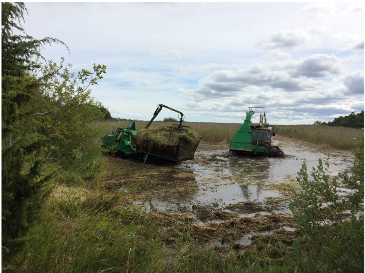
Figur 28. När containern i pistmaskinen är full töms den antingen på marken eller direkt i bandvagnens behållare.
