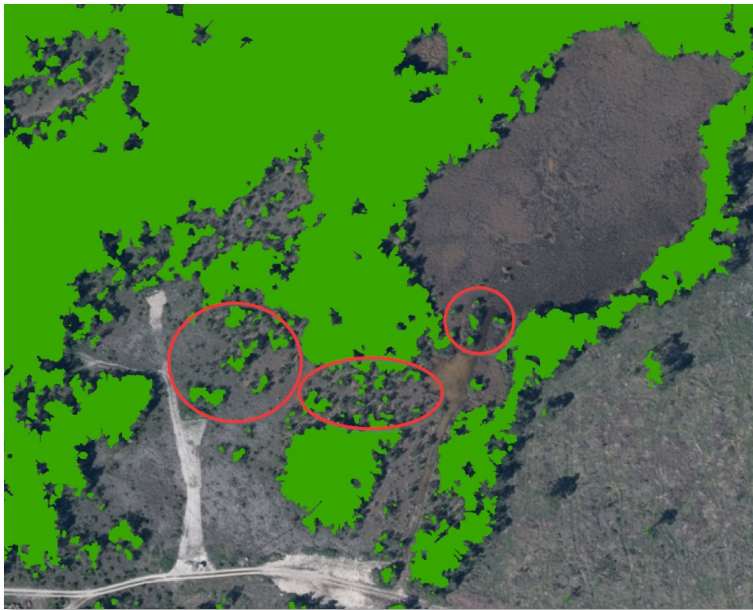
Figur 16: Vegetationshöjd 1,5 m i grönt. Röda cirklar visar exempel på vegetation över 1,5 m och under 5 m som kommer att räknas som andel igenväxningsvegetation.
