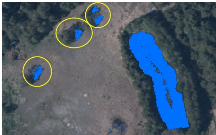
Figur 21: Inom de gula cirkeln har skuggor från träden felaktigt karterats som öppet vatten. Vattnet till höger i bild är däremot korrekt klassat.
