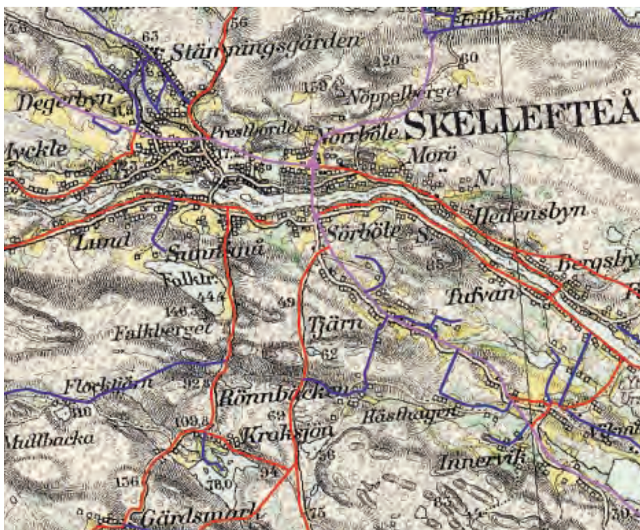
Utsnitt ur generalstabskartan Skellefteå 1906. Till kartan har delar av dagens vägnät fogats. Röda linjer är statliga vägar, blå linjer är enskilda vägar med statsbidrag och lila linjer är Europavägar.
