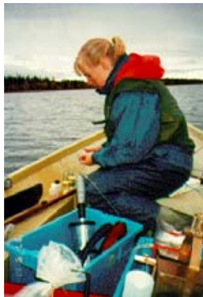
Provtagning av vattenkemi och bottenfauna i Jutsajaure. I den blå backen till vänster finns en Ruttnerhämtare och till höger syns en Ekmanhämtare. Foto: Länsstyrelsen i Norrbotten
