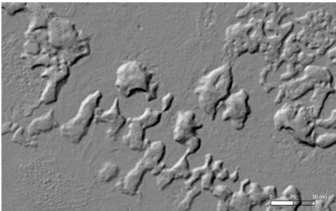
Figur 83 a. Höjdmodell av ett område i den centrala delen av palsmyr 1 i Tavvavuoma baserad på laserskanning 2009.
