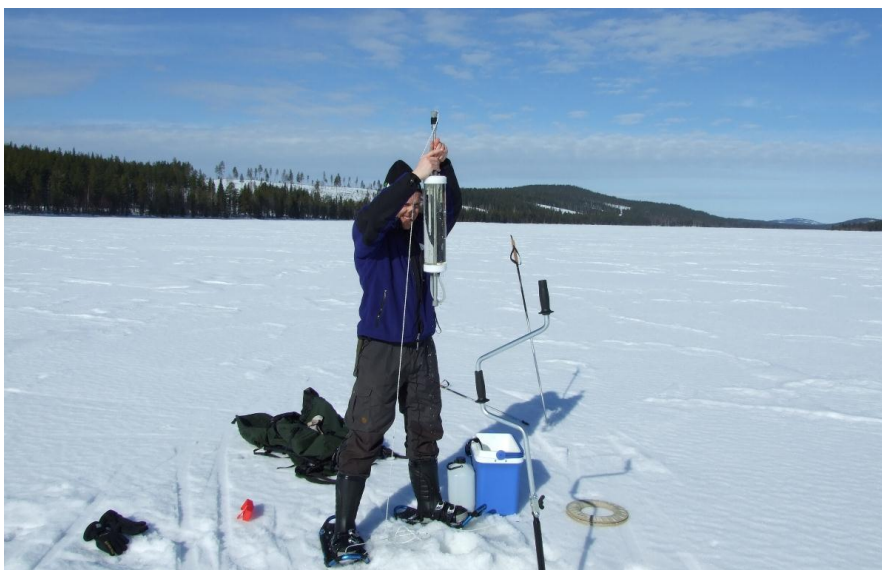
Provtagning av vattenkemi i Vallsjärv. En Ruttnerhämtare används för att ta upp vatten från önskat djup. Foto: Rebecca Möller.
