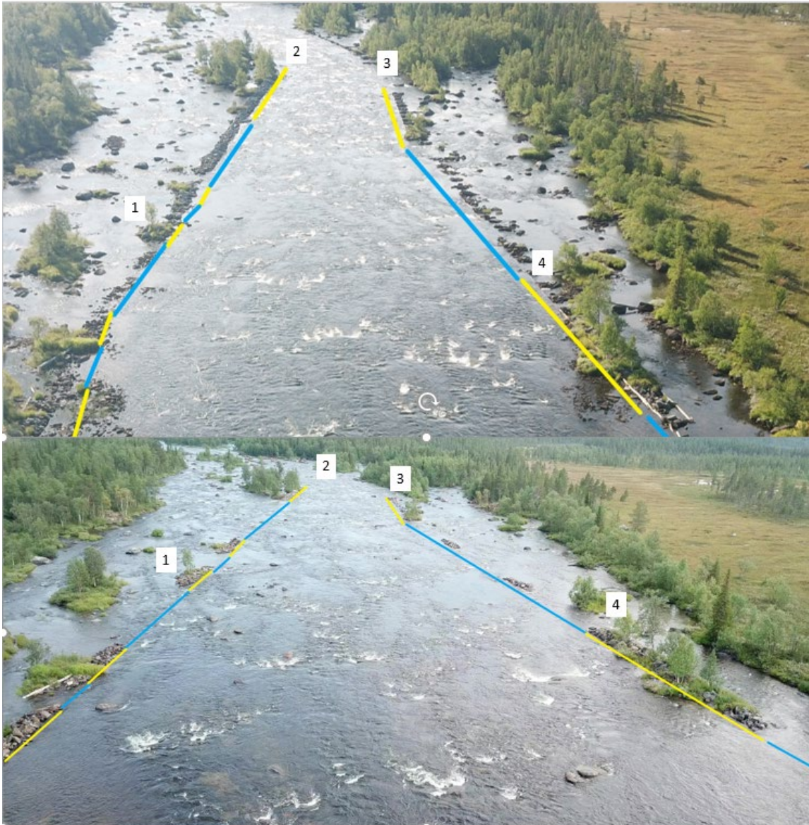
Figur 7. Foton tagna av en drönare. Bilden ovan är tagen före restaurering 2020 och bilden nedan är tagen hösten 2022 efter restaurering. I dialog med arkeologerna beslutades att områdena med de gula linjerna skulle sparas och området med den blå linjen kunde tas bort. Siffran på bilderna är för orientering. Foto: Länsstyrelsen i Norrbotten.
