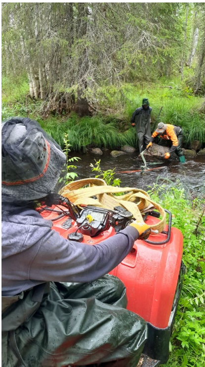
Figur 60. En vinsch från en ATV-maskin användes för att flytta större stenar. Foto: Markku Vierelä, Forststyrelsen.
