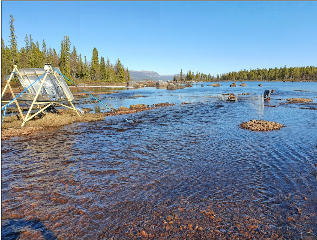
Figur 34. Fiskräknaren, Simsonar FC, återplacerad den 29 maj eftersom räknaren förflyttats på grund av vattentrycket. Instyrningsgaller installerades också för att leda in fisk vid nedströmsvandring. Batteriförvaring samt pc och router för internetuppkoppling förvarades i lättmetallådomna på baksidan av solcellspanelerna. Foto: Länsstyrelsen i Norrbotten.
