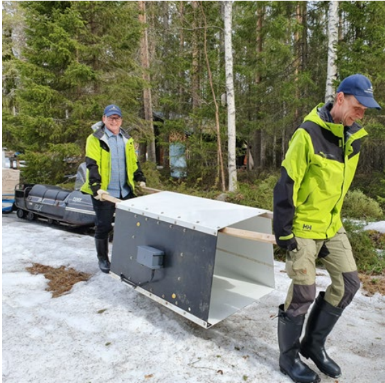
Figur 31. Fiskräknaren består av en fototunnel (vita lådan) med en monterad kamera (grå lådan på den svarta sidoväggen) samt två lysrör på insidan. Foto: Länsstyrelsen i Norrbotten.
