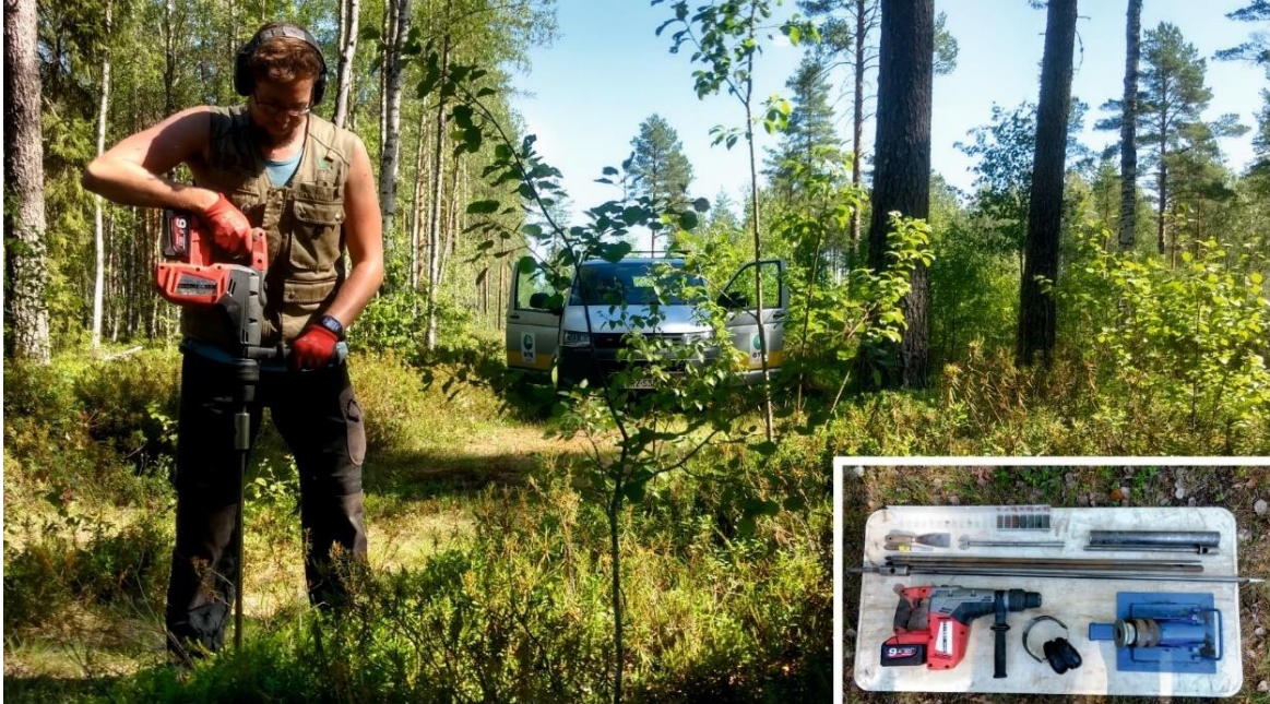
Kuva 6. Pikanäytteenotossa käytettävä laitteisto. Kierrekairan halkaisija on 18 mm, ja sillä voidaan ottaa enintään 1 metrin pituisia näytteitä. Syvemmältä otetaan näytteitä käyttämällä pidennysputkea. Iskuporakoneella hakataan näytteitä maasta. Kuva: Moa Sunabacka, GTK.
