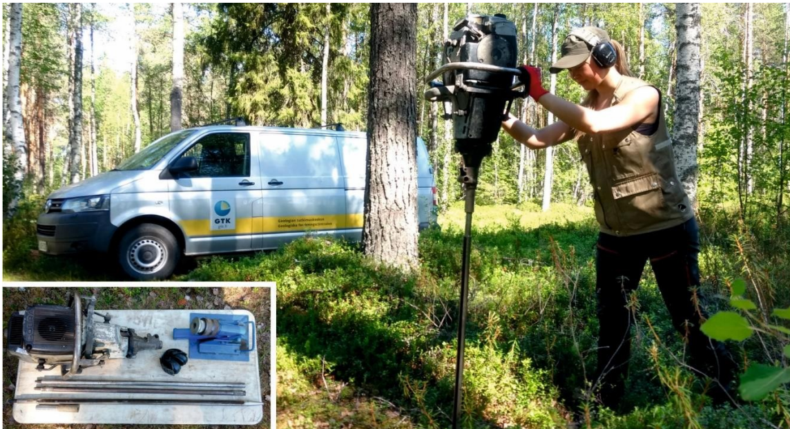
Kuva 7. Tyyppiprofiileissa käytettävä näytteenottolaitteisto. Kierrekairan halkaisija on 32 mm, ja sillä voidaan ottaa enintään 1 metrin pituisia näytteitä. Syvemmältä otetaan näytteitä käyttämällä pidennysputkea. Kierrekaira lyödään alas niin kutsutulla Cobralla. Kuva: Krister Dalhem, GTK.
