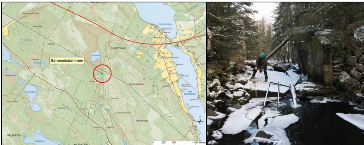
Kuva 4.5. Kartta Rosånista Baronseldammen-pato ympyröitynä sekä kuva betonista ja metallijäänteistä, jotka ovat kaloille vaelluseste.
