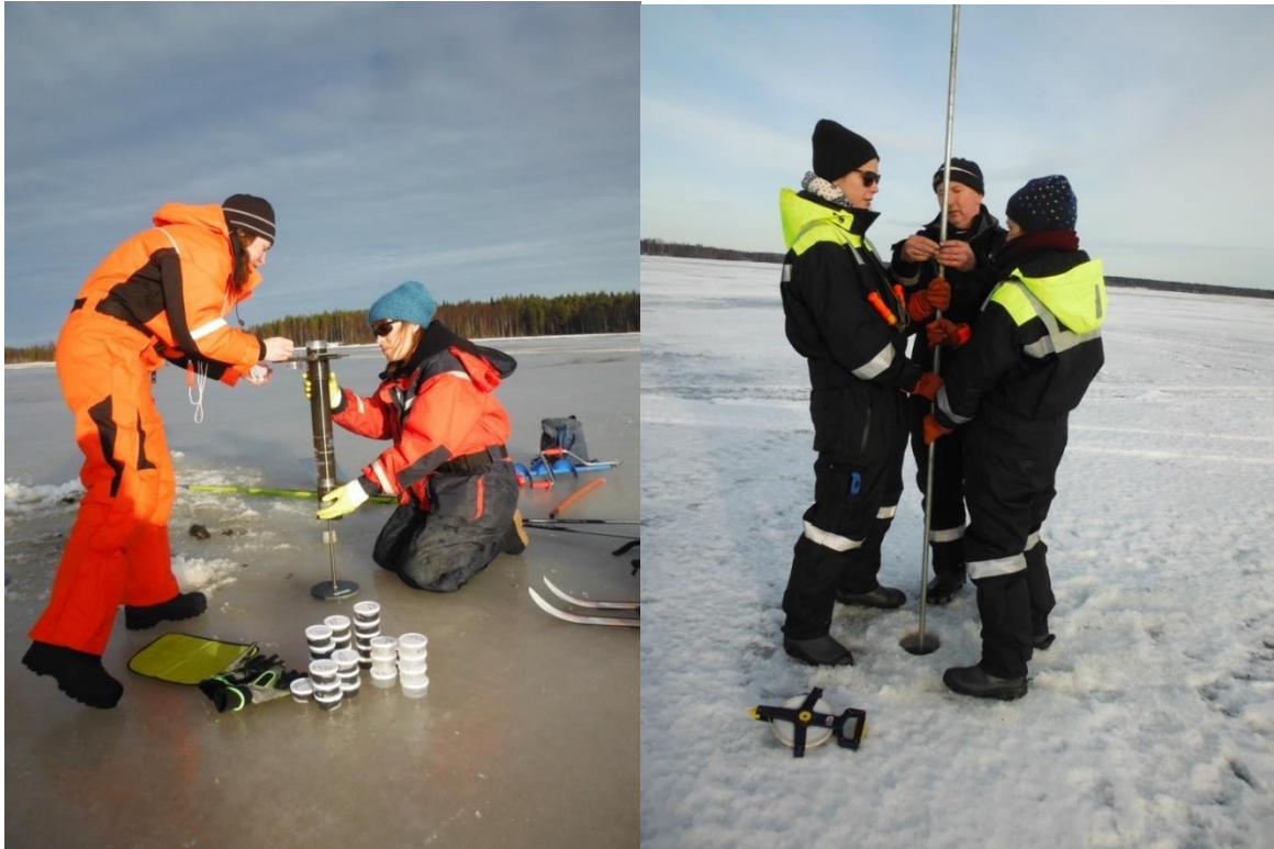
Kuva 9. Vas. Pinta­näyt­teet otettiin Willner-tyypin pinta­näyt­teenot­timella. Ydin pilkottiin tämän vuoksi paikan päällä kahden senttimetrin välein. Oik. Syvem­mällä sijaitsevista sedimen­teistä otettiin näyt­teitä maakairalla. Valokuva: Gustav Sohlenius, SGU.
