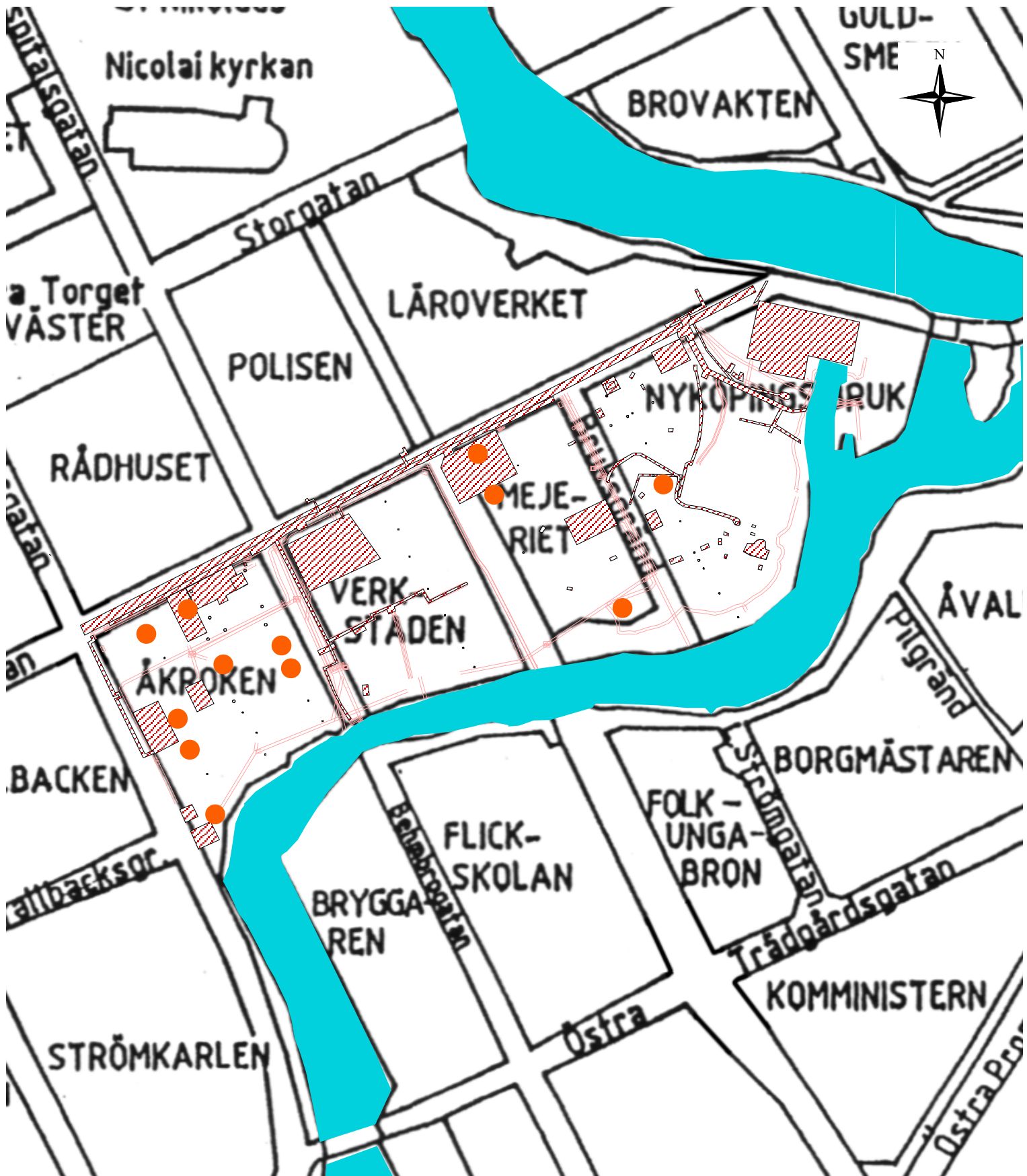
Bilaga 4b. Schaktade ytor inom Åkrosvärden. Bilden visar de kända ytor inom planområdet som är helt eller delvis urschaktade. Både obevakade schaktningar och schakt som bevakats antikvariskt har tagits med i bilden. De orangea punkterna visar platser där man vid arkeologiska undersökningar dokumenterat kulturlager innehållande tegel ända ned på ursprunglig markyta. Skala 1:2000.
