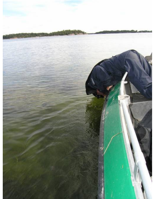
Figur 2. Principen för ”maskvattenkikare”. En person iförd dykmask hänger över relingen på båten som sakta kör över intressanta bottenar. Vegetationen kan på så vis beskrivas översiktligt och vid intressanta fynd stoppas båten.
