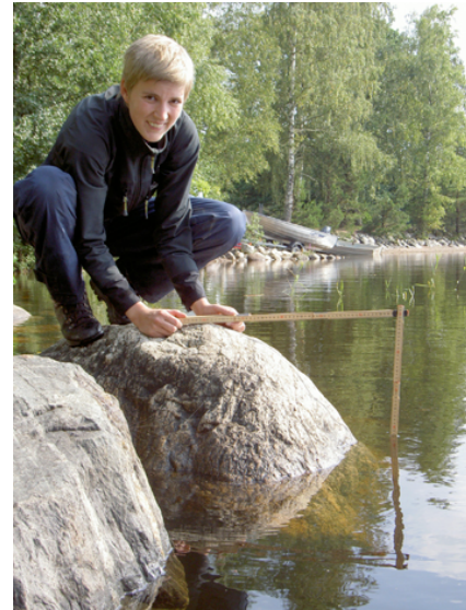
Vattenståndet i Virlången mätes vid X:651871, Y:153432 till 30 cm nedanför stenens topp.
