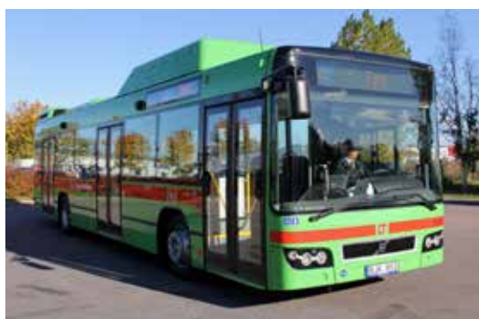
Biogasbuss i stadstrafik, Eskilstuna.
