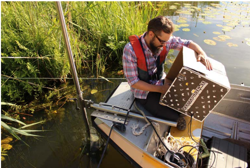
Figur 2. Filmning med ARIS monterad i fören på båt. Foto: Rickard Gustafsson.
